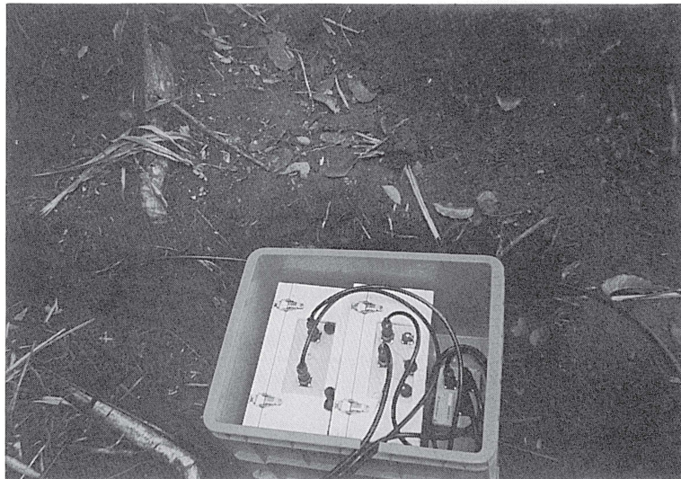
図 4. プロトン磁力計計測部, フラックスゲート磁力計計測部とコネクターボックス, これらを青色のプラスチックケースに収めて設置した。
