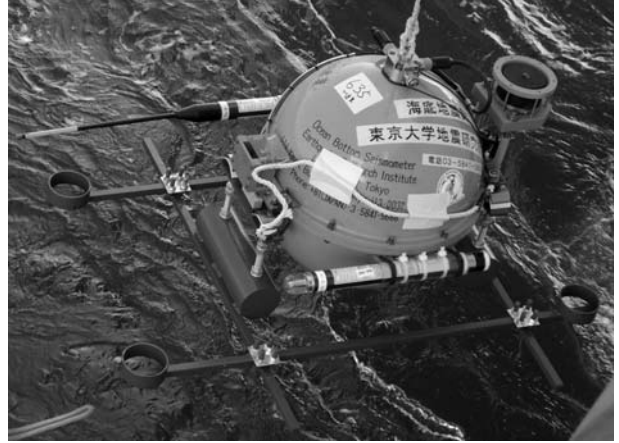
図 2. 加速度計搭載海底地震計. 直径 50 cm のチタン製耐圧球内に, 加速度計 (日本航空電子社製 JA-5typeⅢまたは JA-28GA) を搭載している.
