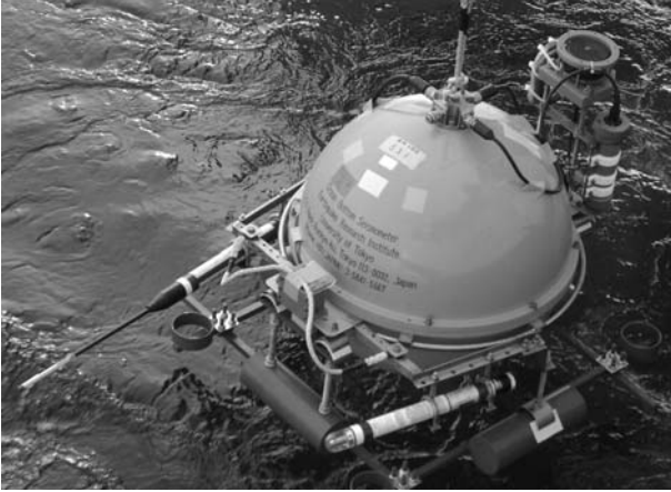
図 1. 圧力計搭載型広帯域海底地震計. 直径 65 cm のチタン製耐圧球内に広帯域センサー (Guralp 社製 CMG-3T) を搭載し, 耐圧球の外装部分に圧力計 (Paroscientific 社製 8B7000-2) を取り付けている.
