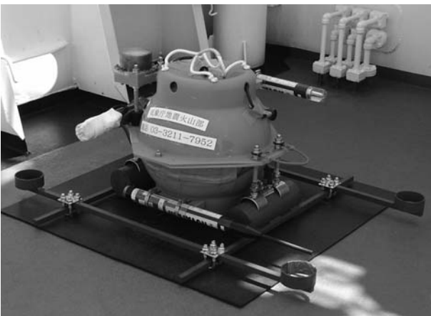
図 11. 気象庁・気象研究所の短期観測型海底地震計. 4.5 Hz 直交3成分地震計とハイドロフォン (HIGH TECH 社製 HTI-99-DY) を搭載している. (平田賢治氏より画像提供)
