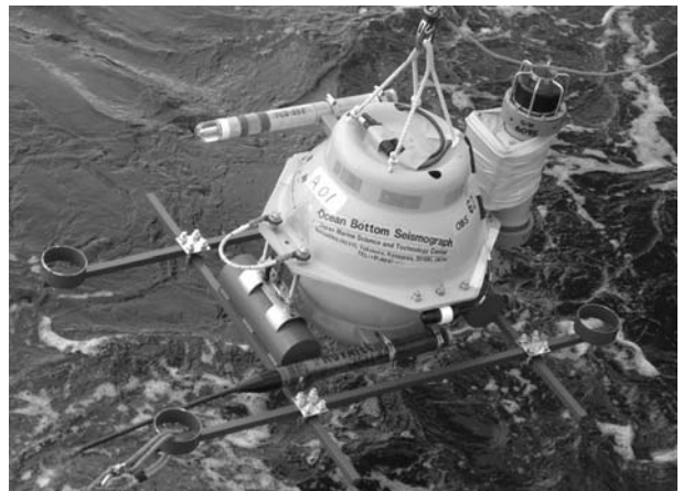
図 10. 海洋研究開発機構の短期観測型海底地震計. 4.5 Hz 直交3成分地震計とハイドロフォン (HIGH TECH 社製 HTI-99-DY または BENTHOS 社製 AQ-18) を搭載している.
