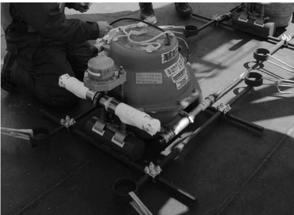
図 5. 1 Hz 地震計を搭載した短期観測型海底地震計. 直径 43 cm のガラス製耐圧球内に 1 Hz 直交 3 成分地震計, レコーダー, 電池が搭載されている. 耐圧球と音響通信装置は, 4.5 Hz 地震計を搭載した短期観測型海底地震計と同じものを使用する. (植平賢司氏より画像提供)
