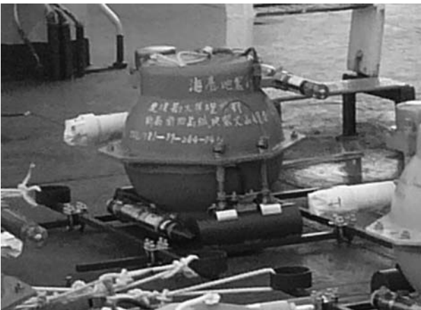
図 9. 鹿児島大学の短期観測型海底地震計. (植平賢司氏より画像提供)
