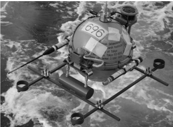
図 3. 1 Hz 地震計を搭載した最長 1 年間連続観測可能な長期観測型海底地震計. 1 Hz 直交 3 成分地震計, 長期観測に対応できる MCXO 搭載のデータレコーダー, そしてそれらに電力を最長 1 年間供給できる電池が直径 50 cm のチタン製耐圧球内に納められている.
