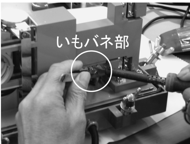
図 3. 半田こてを用いたいもバネ外し
