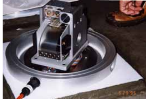
図10 STS 地震計で使われている leaf spring
