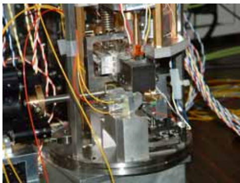
図7 振り子の位置検出用干渉計ユニット(左)とその構造(右)
