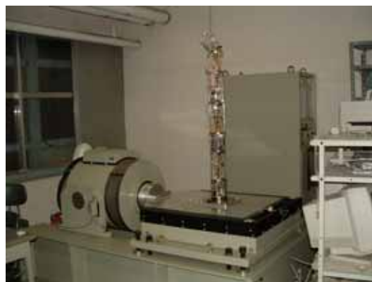
図5 加振台上のセンサー部(ケーシング内)
