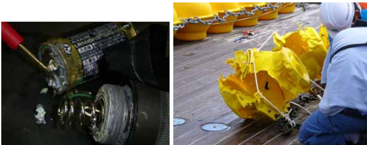
Fig. 7: 海洋係留観測中のトラブル例。漏水による腐食(左)や、水圧による浮力ブイの破裂(右)。
