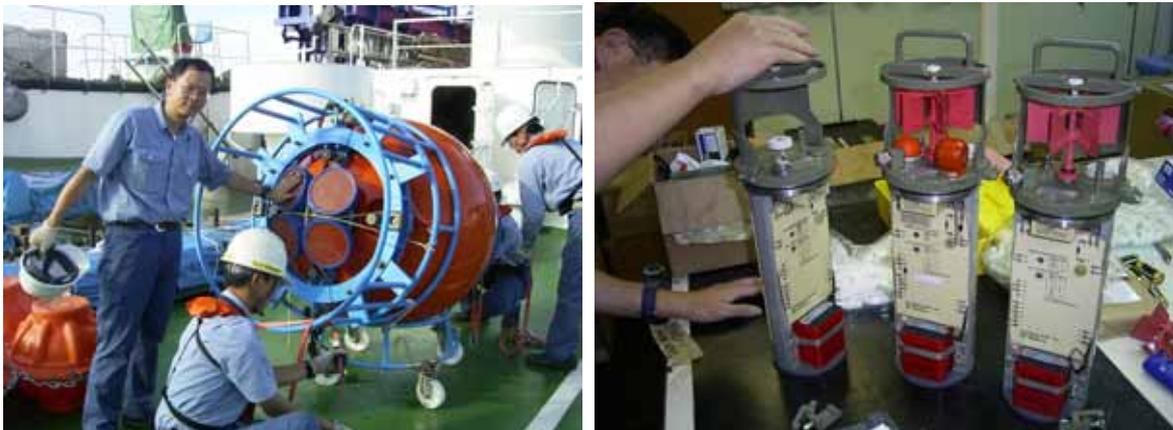
Fig.1: 係留流速計の例。Moored Acoustic Doppler Current Profiler (MADCP; 左)と、プロペラ型ロータの付いた Aanderaa RCM-8 (右)。
