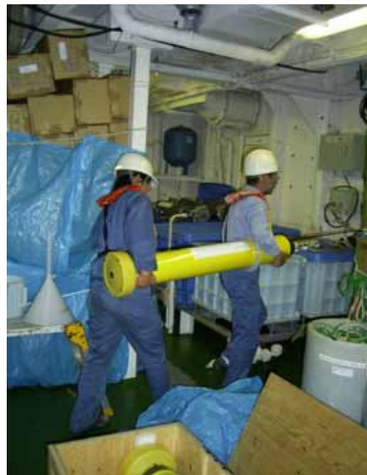
Fig.2: ARGO フロート。自動で浮上して位置と密度プロフィールを衛星に送信し、再び沈降する。
