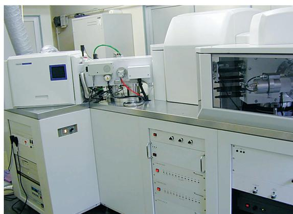
図 1 (本文 p. 2) 地震研究所に設置された Micromass 社のマルチコレクター型誘導結合プラズマイオン源質量分析計 IsoProbe . 高精度同位体比測定が可能なセクタータイプである . プラズマイオン源のためイオン化効率が高く , 従来の質量分析計でイオン化が難しかった元素の同位体比測定が可能である . レーザー削摩装置と組み合わせることにより局所同位体比分析が可能である .
