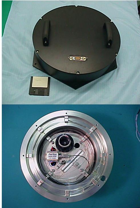
図 2 (本文 p. 6) 開発中の回転成分地震計の写真．上が地震計の外観，下が内部の様子．光ファイバの巻いてあるボピンの内側に電子回路等が組み込まれている．
