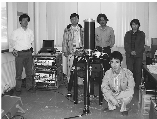
図2 絶対重力計の本体（中央の黒い円筒と三脚）と制御部分．
