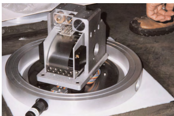
図 1：広帯域地震計（サーボ型地震計）
