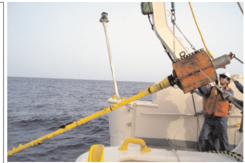
図4：熱流量測定用温度プローブの投入作業
