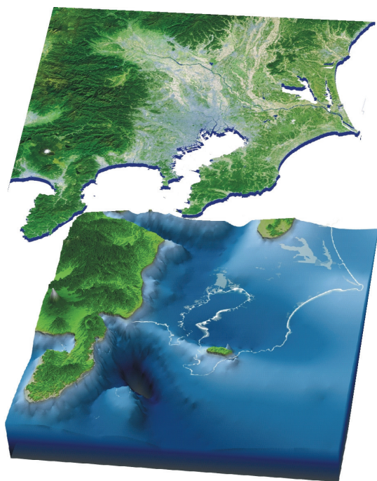
図 2：関東平野の基盤構造。都心—東京湾—千葉県西部にかけて最大 4000m 以上の深さになる。
