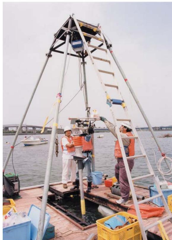
図2．パイプロコアリングによる浜名湖の津波堆積物調査（高知大学松岡裕美撮影）。
