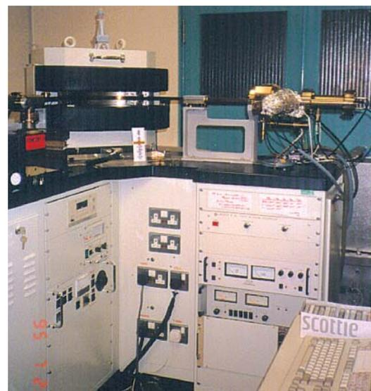
図3 . 希ガス同位体分析用質量分析計 (VG5400) .
