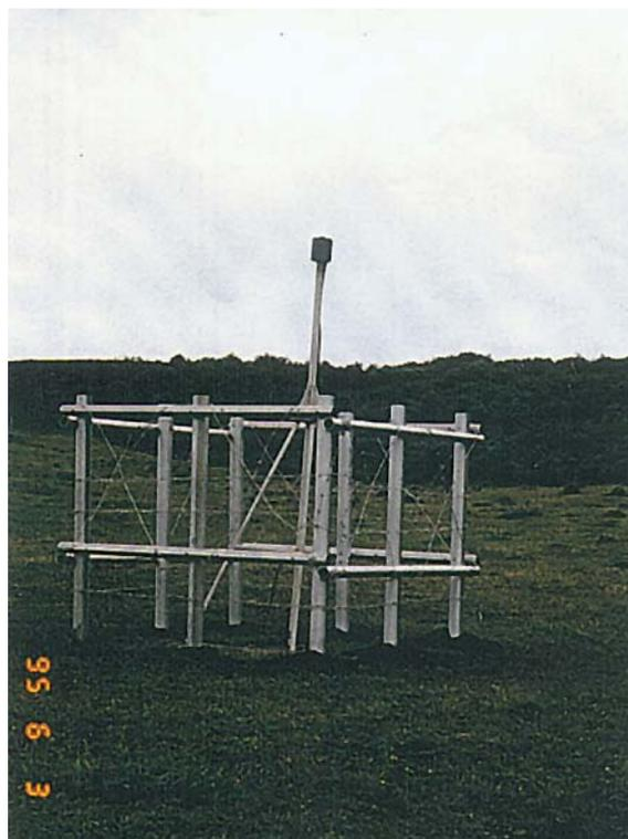
図4. プロトン磁力計のセンサー（三宅島）.
