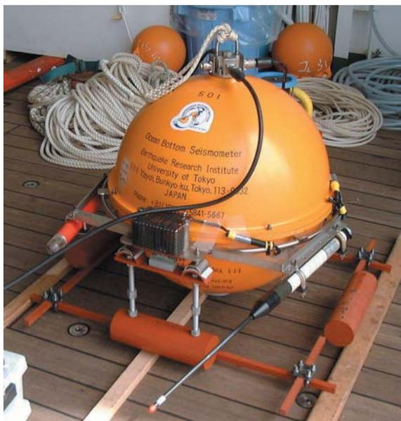
図1 . 自己浮上型長期広帯域海底地震計(BBOBS)の外観 .
