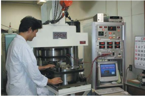
図2 超高压発生装置 (PREM) . 内部に8個の超合金製のアンビルが組み込まれており, 中心部の2-10mm<sup>3</sup>の正八面体の容積に25GPaまでの圧力と2500°Cまでの高温を発生できる .
