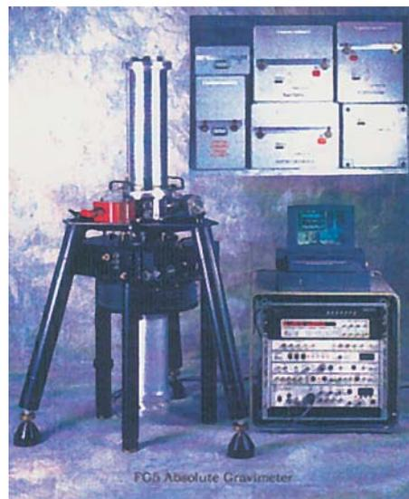
図4 . FG5型高精度絶対重力計 .
