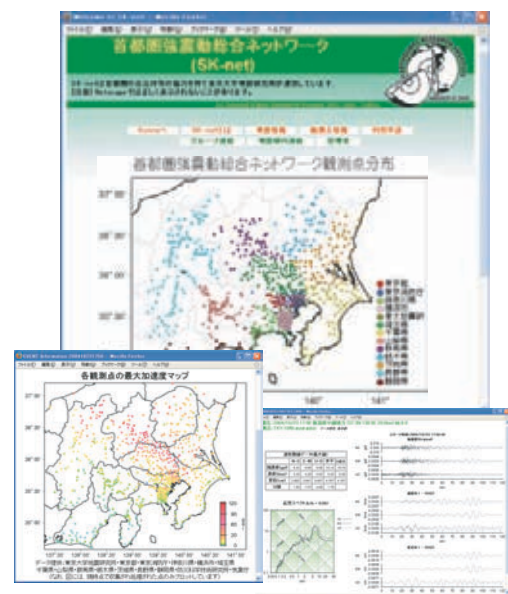
図6 首都圏強震動総合ネットワークSK-net.阪神大震災以降に首都圏の自治体によって設置された強震計・震度計の波形データを収集し「首都圏強震動総合ネットワーク（SK-net）」を構築している。現在、10都県から約930点の観測点における強震波形データが収集されており、Webで公開されている。
