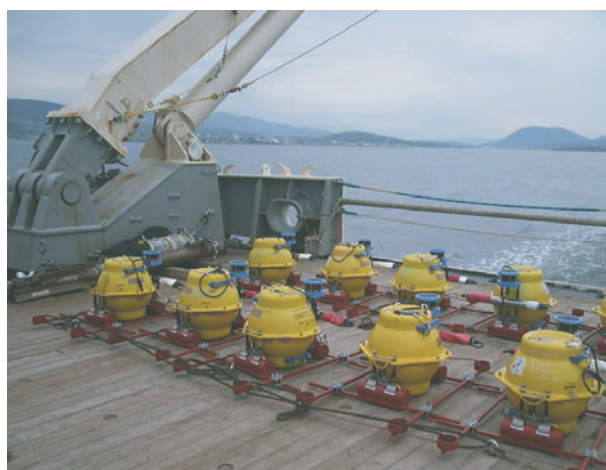
甲板上に並ぶ自己浮上式海底地震計。
