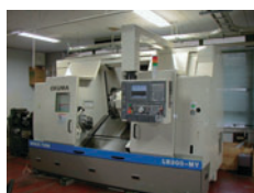
ターニングセンター（ミリング加工可能なNC旋盤） Turning-Center: A numerical control lathe with milling.
