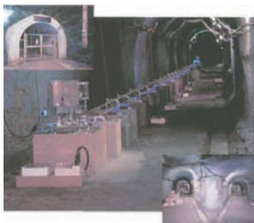
鋸山地殻変動観測所坑内水管傾斜計・伸縮計（中央）、観測坑入口（左上）、および坑内分岐点（右下）。 Nokogiriyama Geophysical Observatory: Watertube tiltmeter and extensometer (center), the entrance (upper left), and a junction in the vault (lower right).
