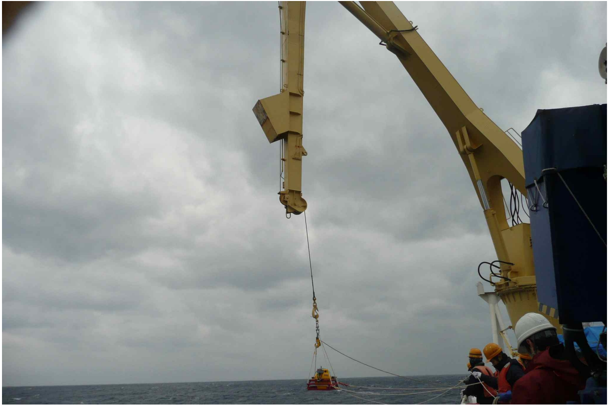
「みらい」のクレーンを使った自由落下方式による広帯域海底地震計設置作業風景。
