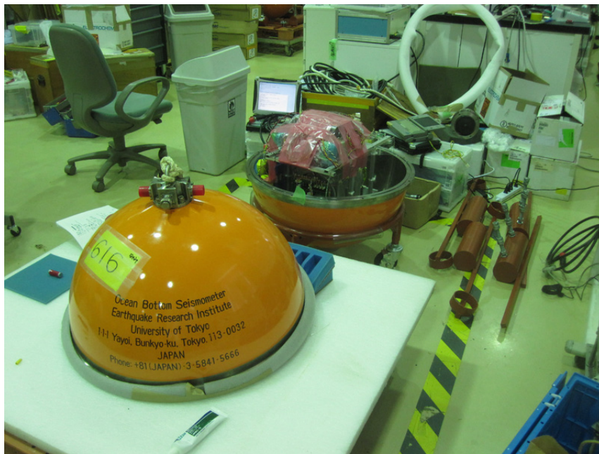
図 6. 組立整備中の広帯域海底地震計。高精度絶対水圧計が付加される。
