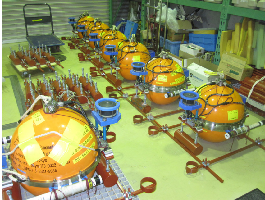
図 7. 整備の完了した長期観測型海底地震計
