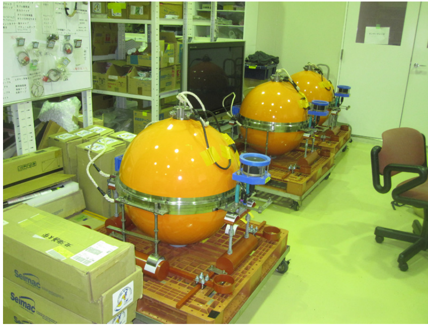
図 5. 整備の完了した広帯域海底地震計
