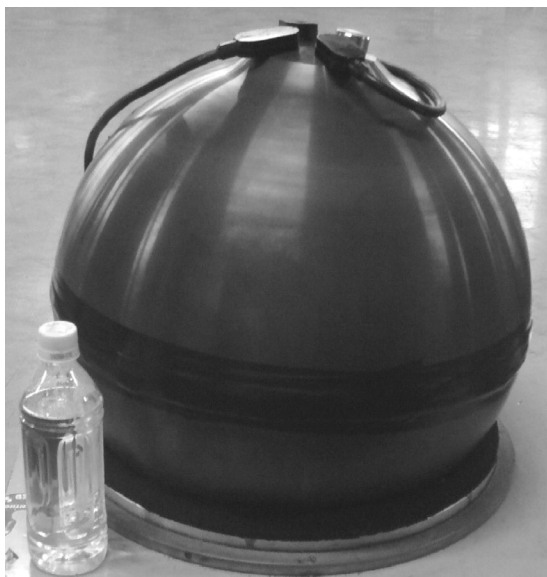
図5 超深海型海底地震計用耐圧容器。
