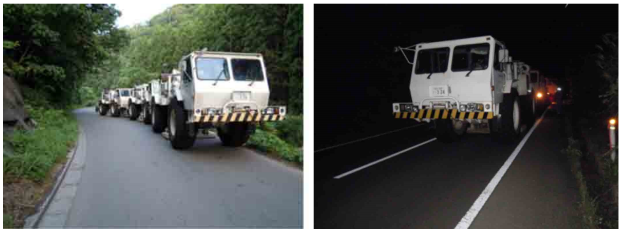
図 4 バイブレータ発震作業（左：丸森町金ヶ作、右：七ヶ宿町中川原[夜間発震]）
