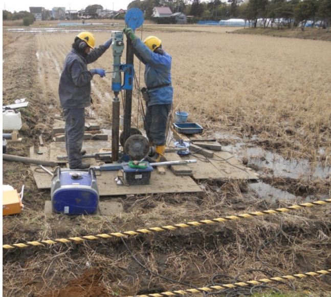
写真3 可搬型打撃式定方位簡易ボーリングによる試料採取
