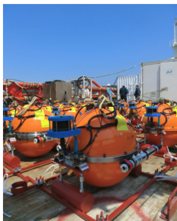
観測船甲板上に並ぶ長期観測型海底地震計と設置作業の様子。
