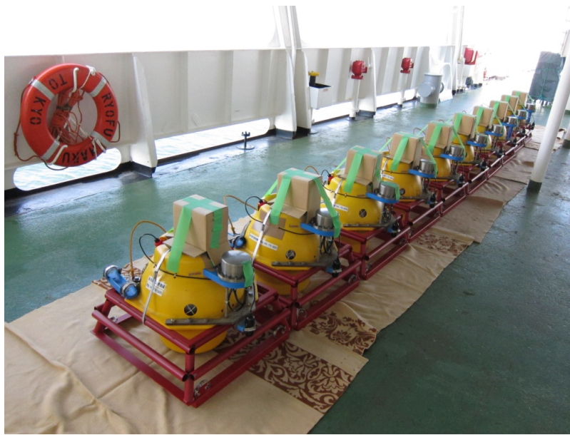
図1 気象庁「凌風丸」船上での海底地震計
