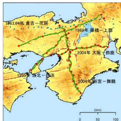
図 1 本研究で用いた人工地震を用いた地殻構造観測測線。緑の点は観測点、赤の星は発破点、赤丸はパイブロサイス多重発振点を示す。赤線は活断層を示す。
