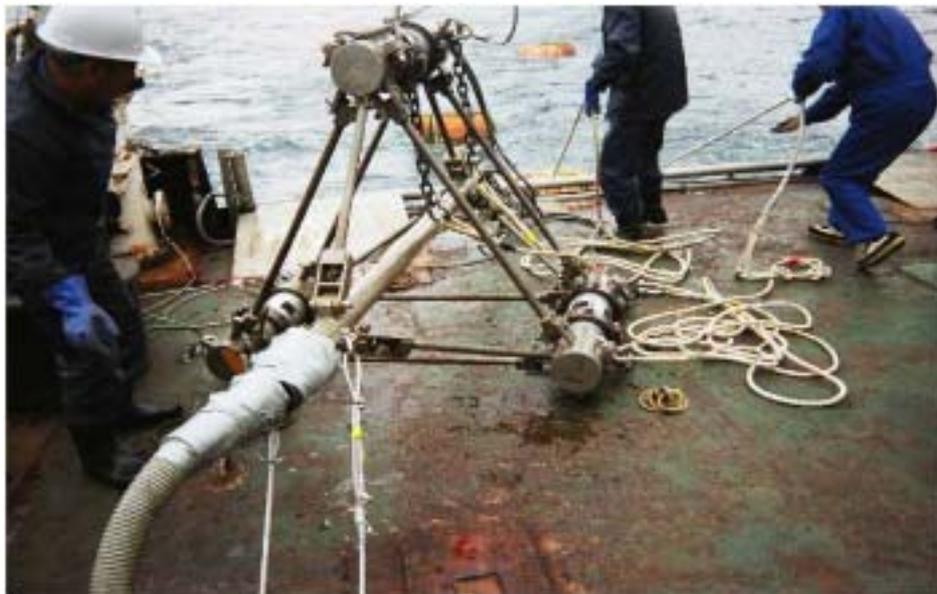
図10 トリガン型エアガン(米国Bolt社製)。
