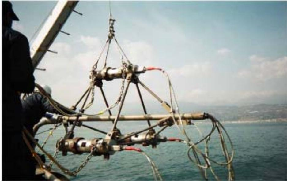
図9 エアガン第一クラスター(200cu. inch×3基)。
