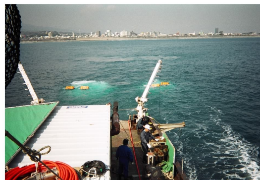
エアガンの発震作業 (船尾の気泡はエアガンの発震による 1.3.1 参照)
