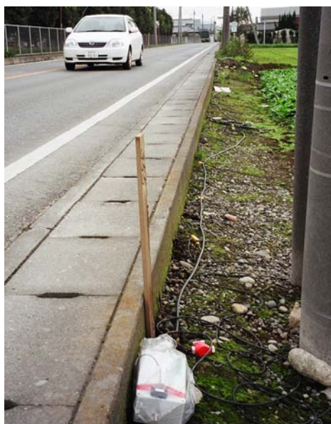
写真4 群馬県新田町新田北部工業団地近傍 （RP. 355）。S 波観測 LS8200 設置状況 (1)
