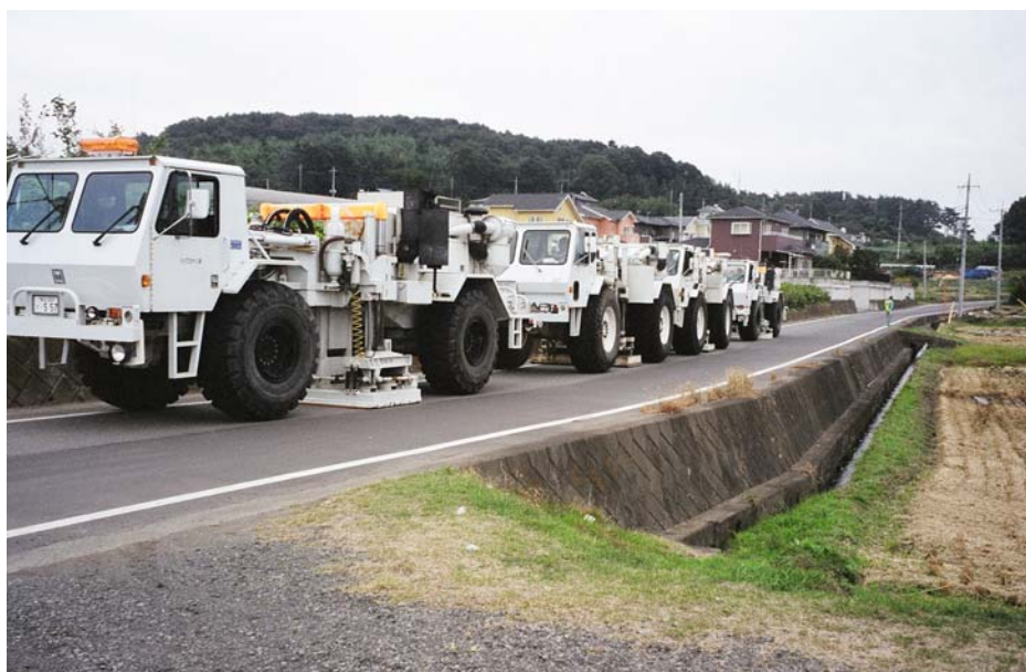
写真6 バイブレーターによる発震作業。 鹿田山北地区町道。この地域の一部では古第三紀流紋岩類の露頭が散在している。
