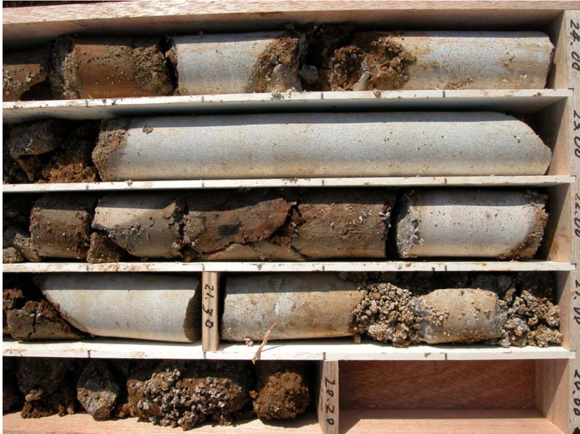
図 18 深度 20～24m 付近の輝石安山岩。クラックに沿って著しく風化変質し、一部は土壌化している。
