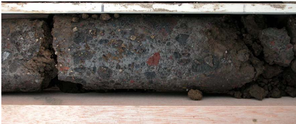
図 19 深度 49m 付近のスコリア質凝灰角礫岩。非常に淘汰が悪く、基質支持。
