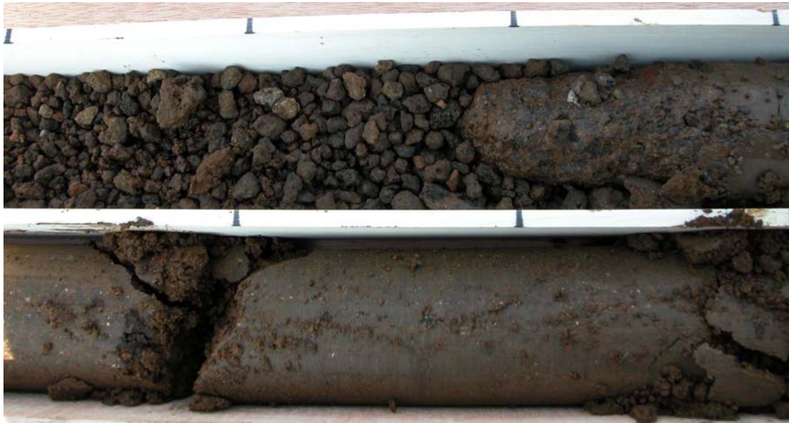
図17 コア最上部（深度4m）付近のローム化したスコリア層。コア箱の目盛り間隔は10cm。最上部は40cmは基質をほとんど含まず、多孔質で細礫大のスコリアのみが回収された。
