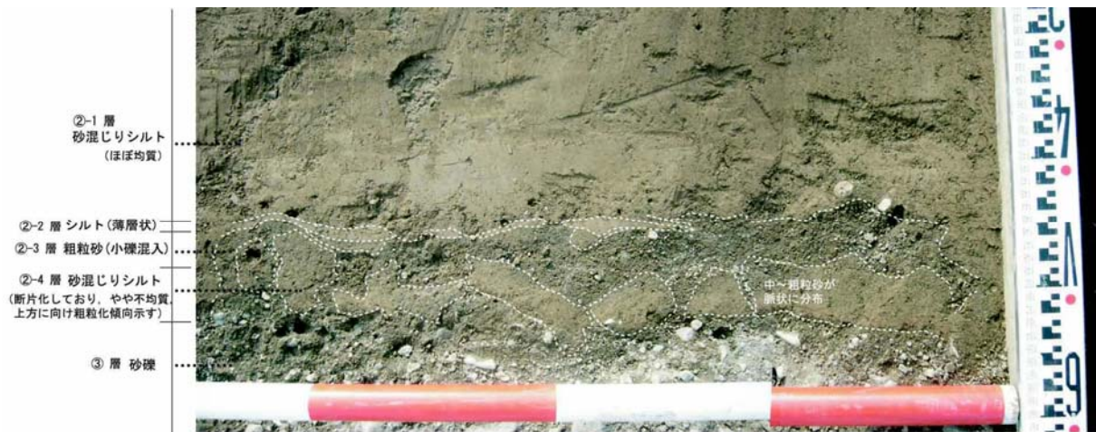
図8 幅1.2mのジオスライサー断面WideGSの拡大写真
