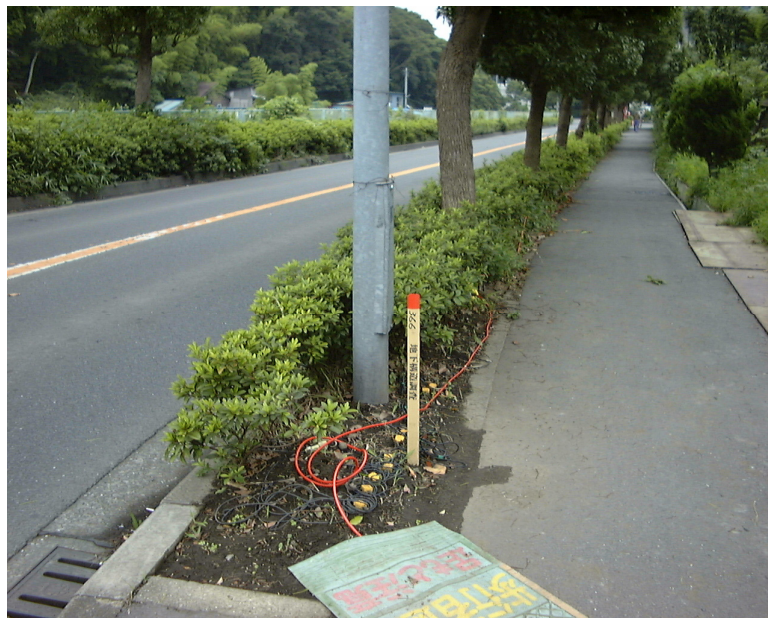
写真3 受振点。 三浦半島陸域での受振器・本線ケーブル。
