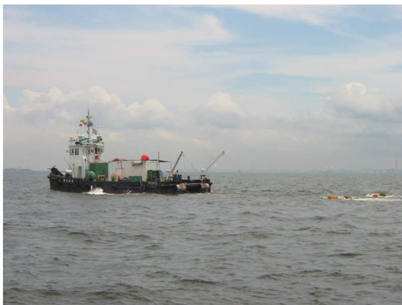
写真8 エアガン発震作業。エアガンを曳航する発震船「はくほう」。
