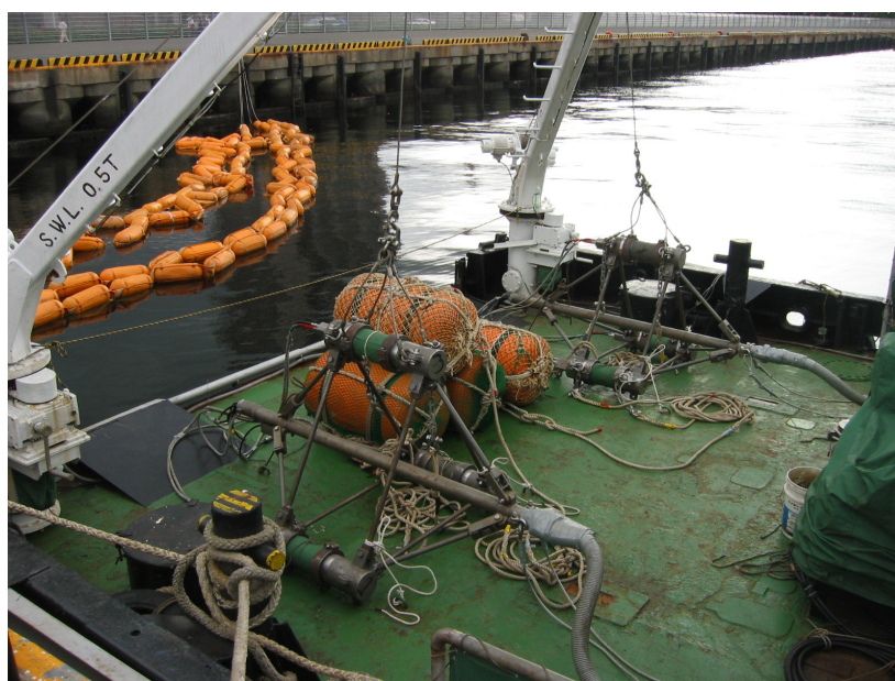
写真10 エアガン。 Bolt 1500LL Tri-Gun。
