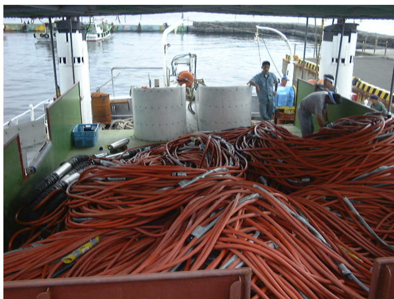
写真6 海底ケーブル型受振器 Ocean Bottom Cable (OBC)。
