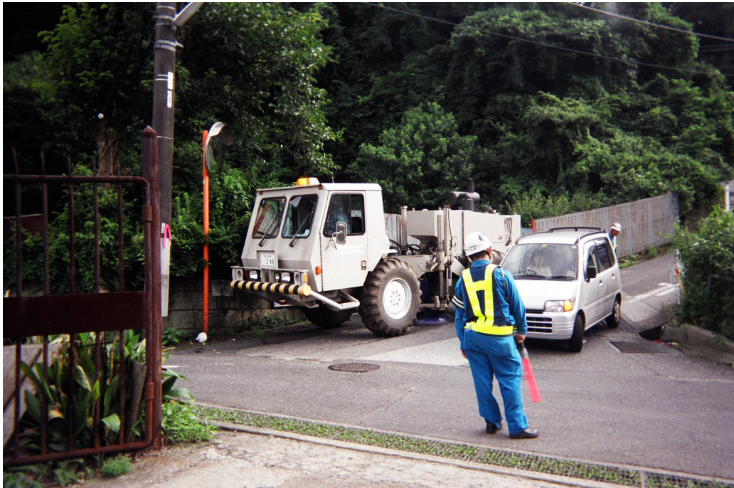
写真2 ミニバイブレータ発震 三浦半島陸域。 住宅密集地や細い道路では、小型バイブロサイズ車を震源として使用した。
