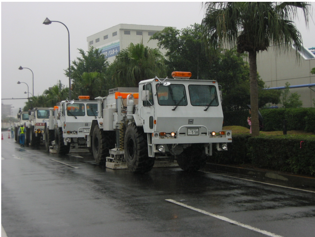
写真1 バイブレイタ発震。三浦半島陸域（横須賀市平成町）。
