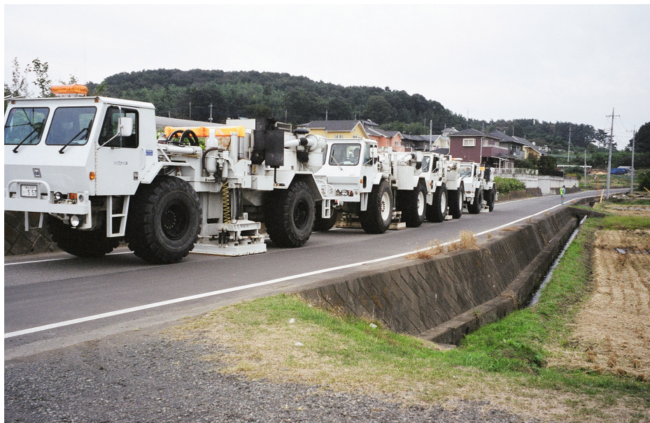
写真6 バイブレーターによる発震作業。 鹿田山北地区町道。この地域の一部では古第三紀流紋岩類の露頭が散在している。
