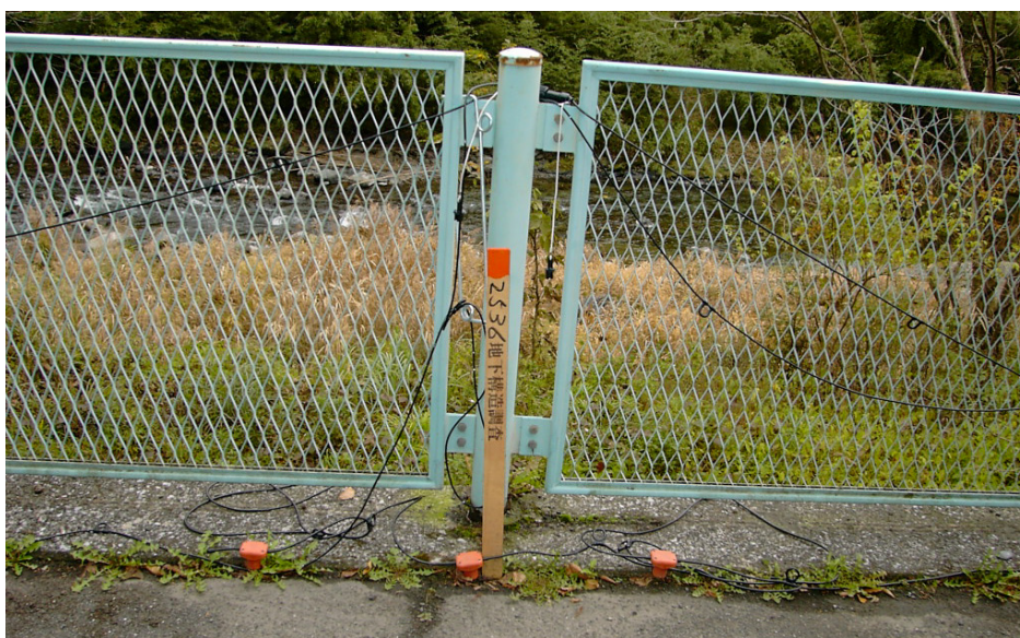
写真1 埼玉県名栗村下名栗地区県道 53 号青梅秩父線。 入間川護岸に設置された受振器 UM-2、受振番号 RP. 2536 地点。
