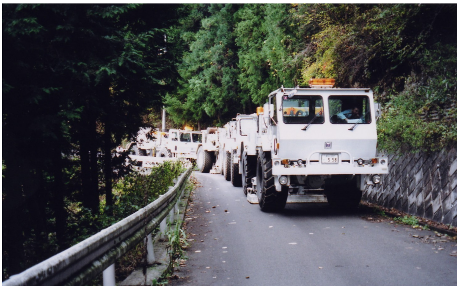
写真7 バイブレーターによる発震作業 林道西多摩-大入線。
