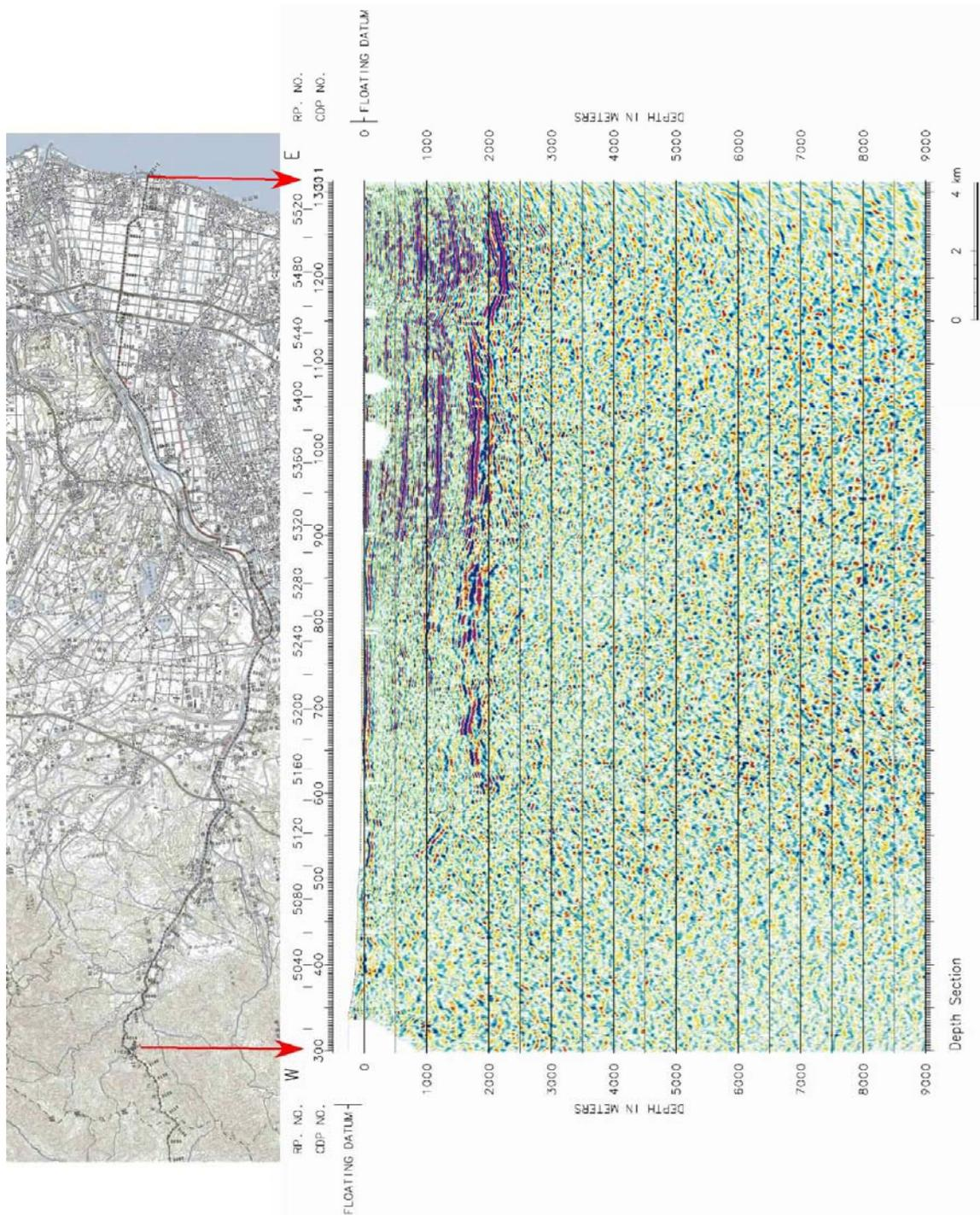
図 65 深度断面図 [3] 鈴鹿測線 CMP 重合+‘周波数-空間領域差分時間マイグレーション+深度変換
