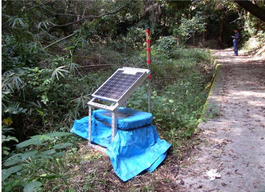
写真 1 観測装置のデータ収録部。太陽電池パネルと GPS アンテナが取り付けられたポール。アングルの下のコンテナにはデータロガーとバッテリーが格納されている。
