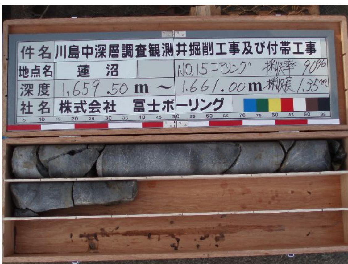
図 1 1 深度 1659.5-1661.0m（孔底）のコアサンプル（先新第三系の硬質灰色中粒砂岩）
