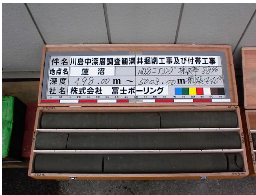
図 1 0 深度 500m のコアサンプル（上総層群の緑灰色泥岩）
