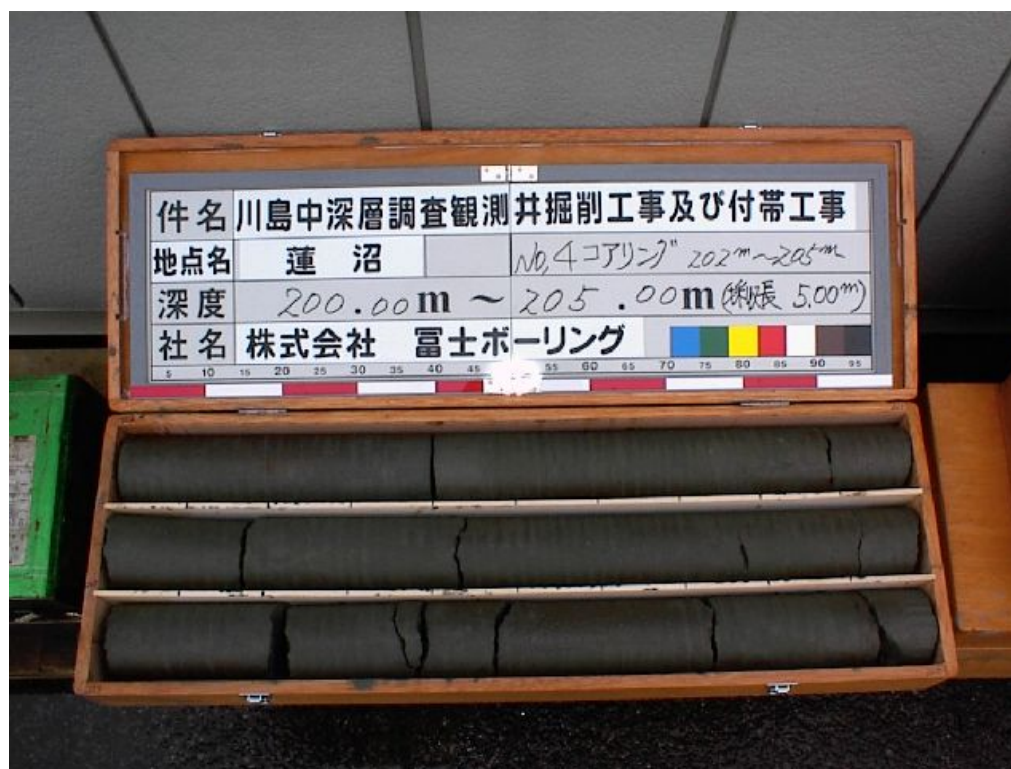
図9 深度200mのコアサンプル（上総層群の緑灰色泥岩）
