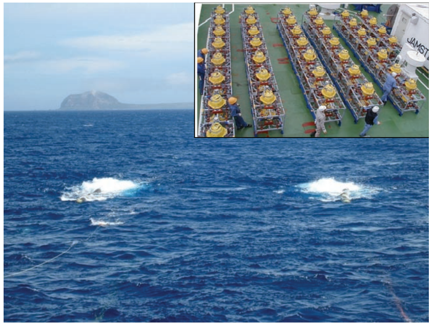
図1 大容量エアガンを用いた人工地震による地殻構造探査の様子と甲板にならべた海底地震計(右上)。
