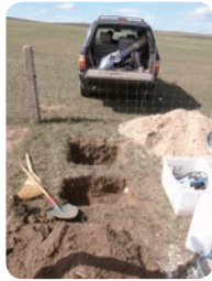
図2 観測点設置の様子 個人の家の庭先を借りて、穴を掘り、広帯域地震計と収録計を設置する。電源がない所では、太陽電池パネルを設置する。
