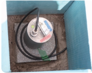
図2 観測点設置の様子 個人の家の庭先を借りて、穴を掘り、広帯域地震計と収録計を設置する。電源がない所では、太陽電池パネルを設置する。
