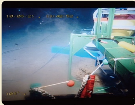
図2 新型海底電位差計 左はケーブル展張部。無人探査機で曳航し、このプロジェクトでは3km長のケーブルを海底に敷設する。右は、記録部と敷設したケーブルの片端。
