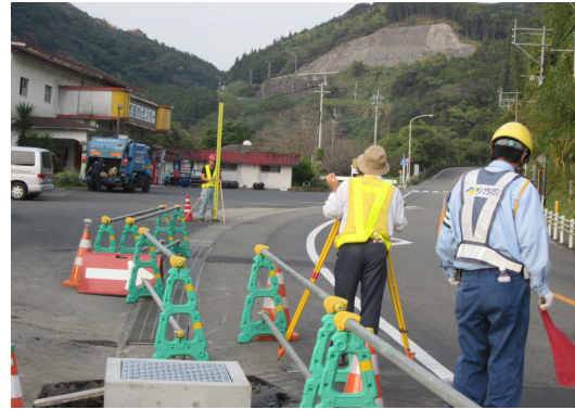
写真3 水準点移設接続測定
