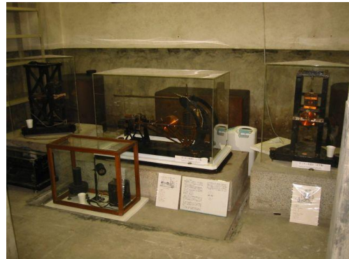
写真2 地震計展示 (ガリチン地震計)
