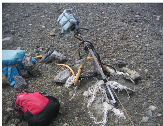
図1. 火山ガスによって腐食したカメラ機材
