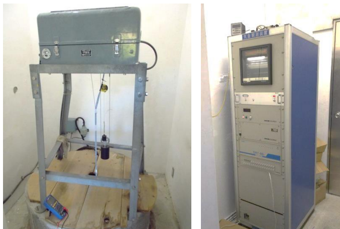
写真1 検定中のフース型検潮儀(左)と収録装置(右)
