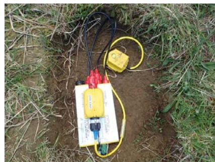
図2. GSX 設置写真(埋設前) 穴を掘ってGSX一式を設置する
