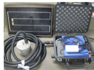
図1. 標準観測セット。樹脂ケース内の青 Box は装置本体、白 BOX は 3G アンテナ。
