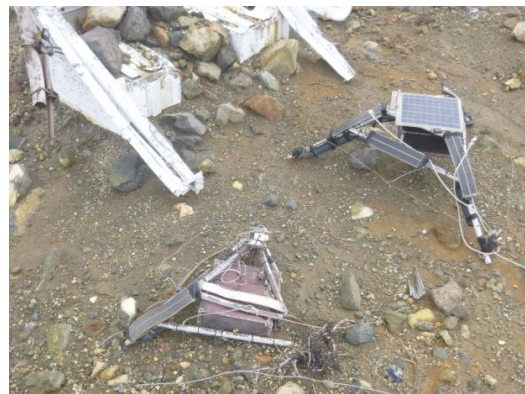
口永良部島に設置した地震観測装置. 手前は2015年4月17日に設置して5月29日の噴火で破壊されたもの. 右は2015年9月10日に再設置したもの. いずれも2016年7月18日に徒歩で回収した. 左上の白い架台は噴火で被災した京大桜島の古岳観測点.
