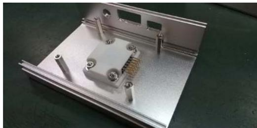
写真 3. 評価ボードの固定具
