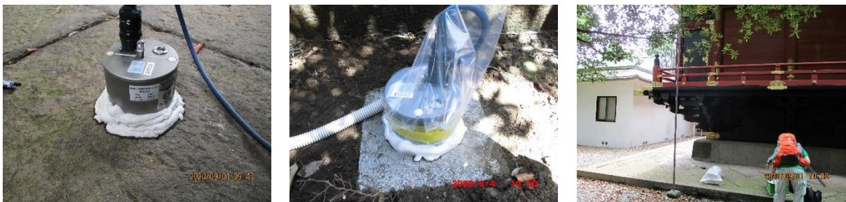
図 2. 観測点設営風景。左写真はレナーツ地震計をコンクリートに直接石膏止めした様子。石膏が固まった後、真ん中の写真同様ビニール袋を被せ保護している。真ん中は厚さ 3 ~ 5 cm 程のコンクリート板を、掘った地面に埋設し地震計を石膏で固定した様子。右写真は設置状況の様子。根津神社本殿の脇に設置させていただいた。
