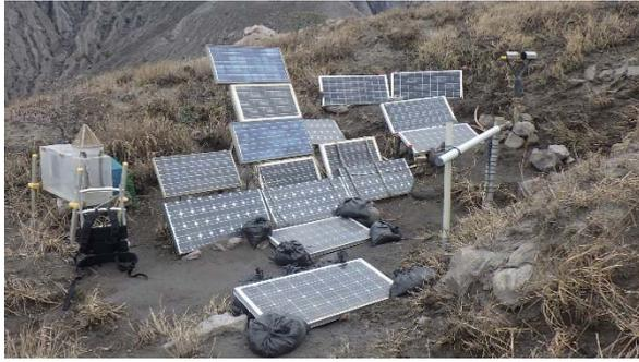
図 2. 強靱化前の引ノ平観測点ソーラーパネル配置図. 右側にある横長の筒がデータ伝送用無線 LAN アンテナ.
