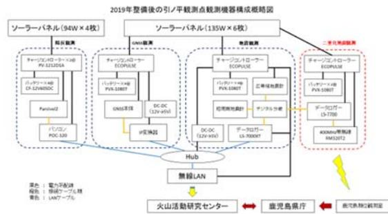
図 5. 強靱化後の引ノ平観測点観測機器構成概略図.
