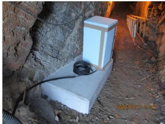
図2 新設の地震計台と地震計。縦長の箱は断熱材で中に広帯域地震計がある。
