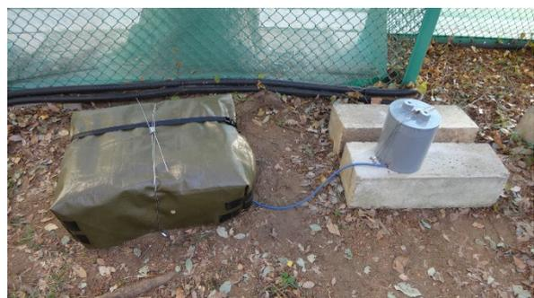
図 4：観測時の設置イメージ。右側に地震計と地震計カバー，左側に防水ケースがあり，防水ケースはビニールシートで覆われている。
