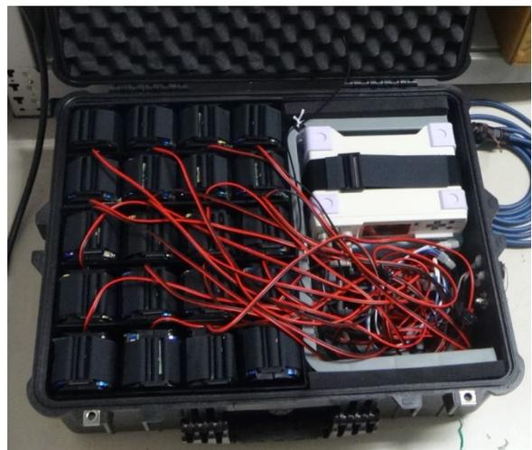
図 3：防水ケースの内部。左側に 20 式の単 1 乾電池 8 直ケース，右側に収録装置が収納されている。
