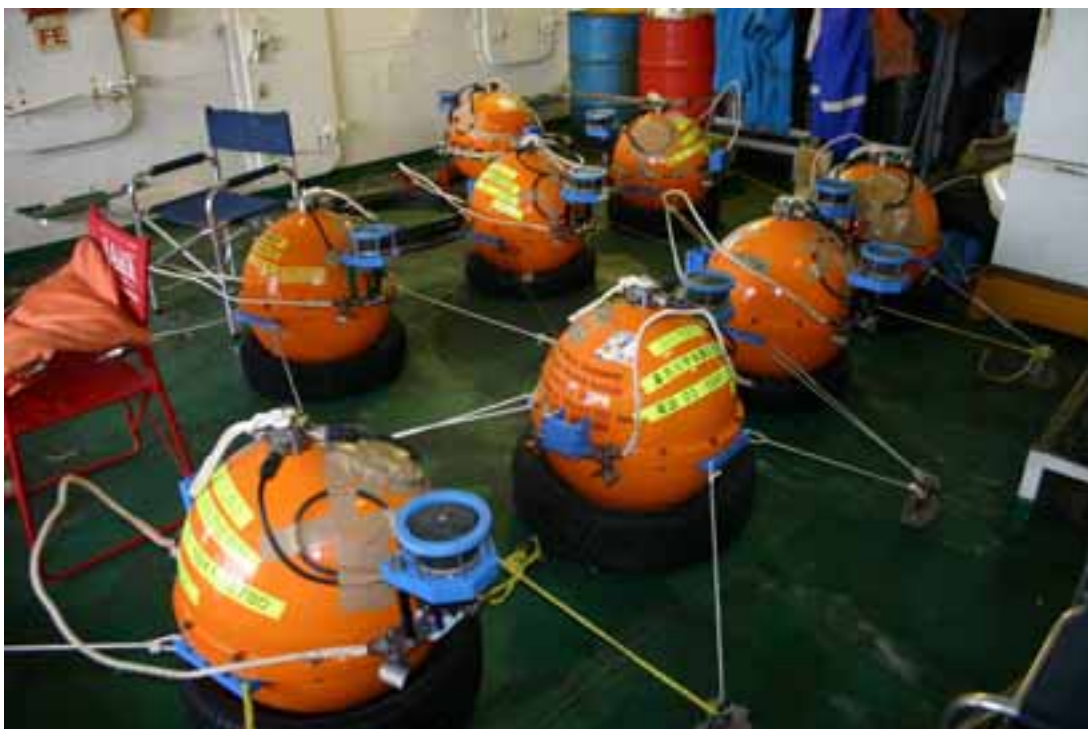
図5 回収した長期観測型海底地震計(平成16年11月新世丸用船航海)
