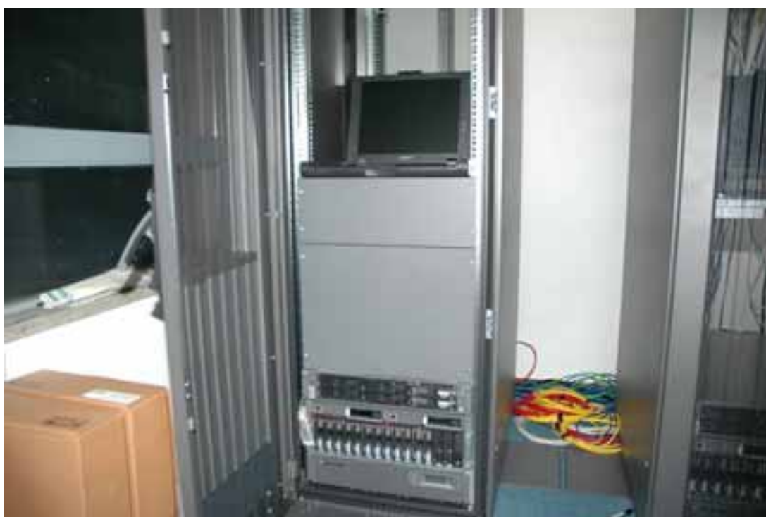
図9 新規整備した長期観測 OBS 記録処理システム 大容量 RAID ディスクを備える。
