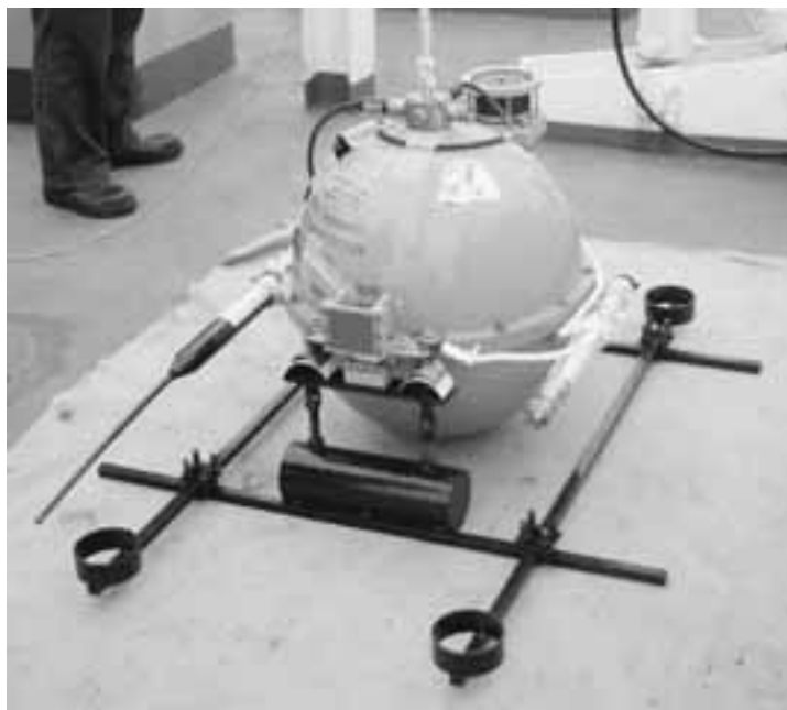
図2. 本作業で設置する海底地震計 (海中に投入する直前の海底地震計の外観)
