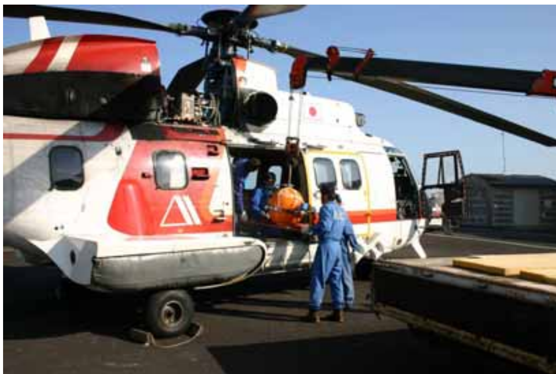
図2 東南海・南海地震想定震源域に海底設置（平成17年10月）のため大型ヘリコプター機内に搬入中の長期観測型海底地震計
