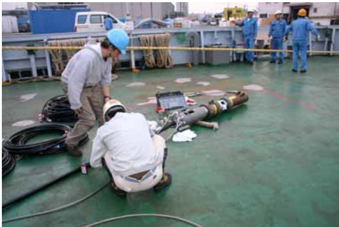
図8 反射法地震探査のため準備作業中のエアガンシステム(平成16年11月新世丸用船航海)
