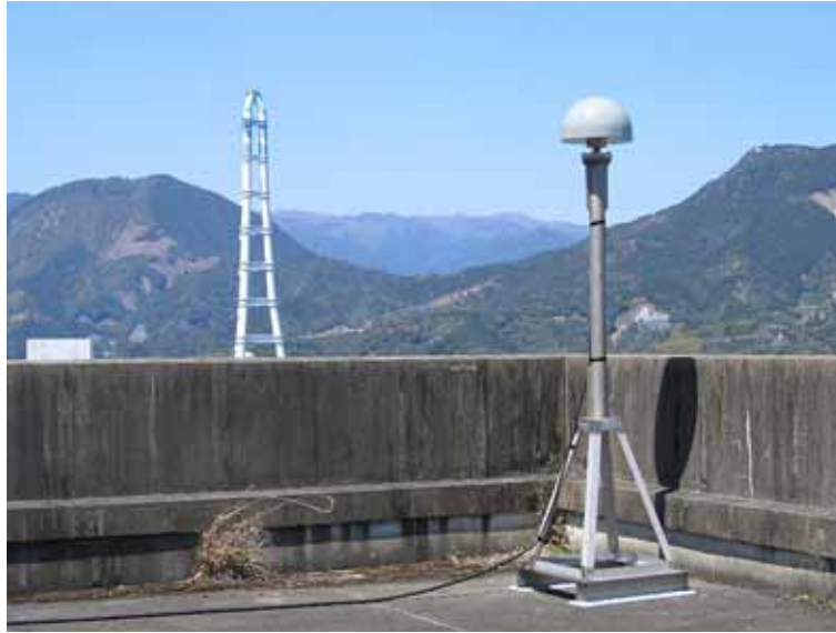
写真3 キネマティック GPS 基準局（尾鷲）の設置状況
