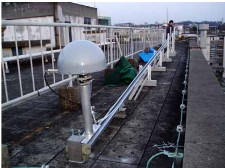
写真 4 実験に用いたスライダと GPS アンテナ
