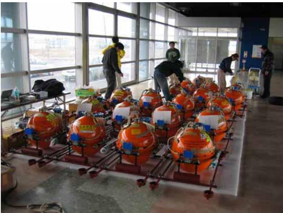
図2 設置前の最終調整作業中の長期観測型海底地震計（青森県八戸市の臨時ヘリポート近くの臨時作業スペースにおいて）
