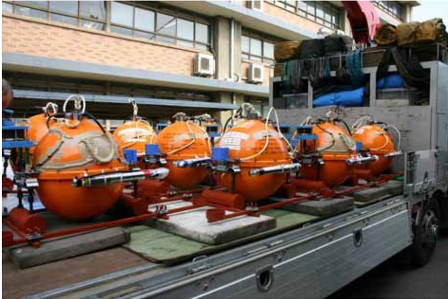
図1 青森県八戸市の臨時ヘリポートに輸送するためトラックに積み込んだ長期観測型海底地震計
