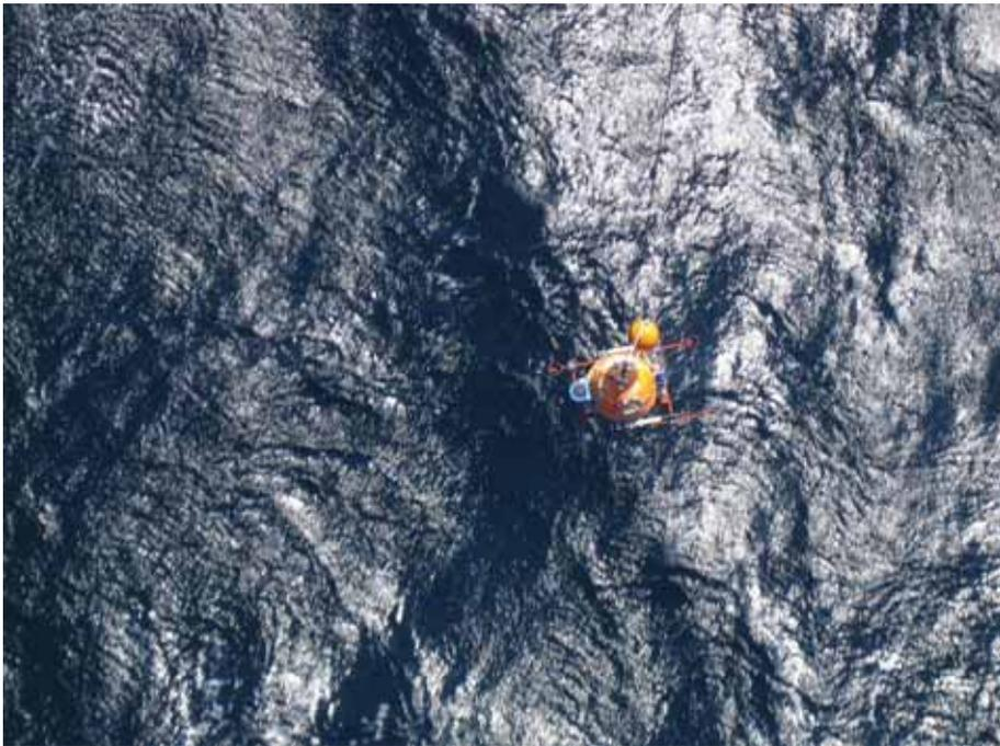
図5 海底設置のため大型ヘリコプターから吊り降ろし中の長期観測型海底地震計
