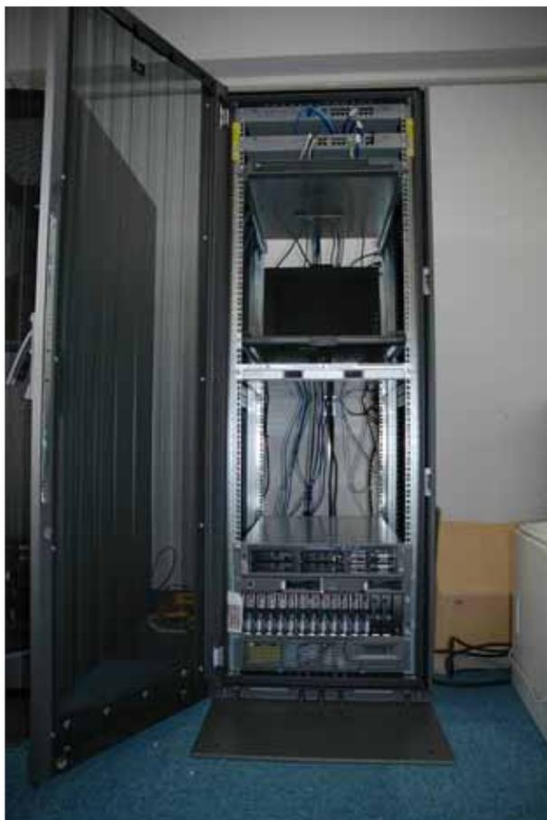
図7 新規整備した大容量 RAID ディスクの長期観測 OBS 記録処理システム
