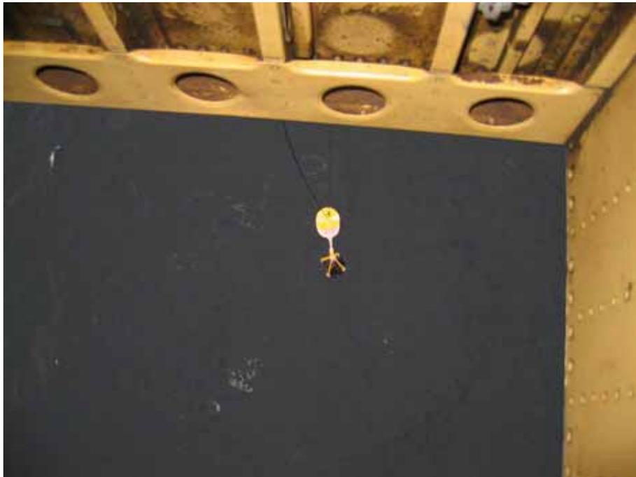
図 12 海底地震計の海底設置位置を試験的に決定するため、ヘリコプターより吊り降ろした音響通信装置トランスデューサー
