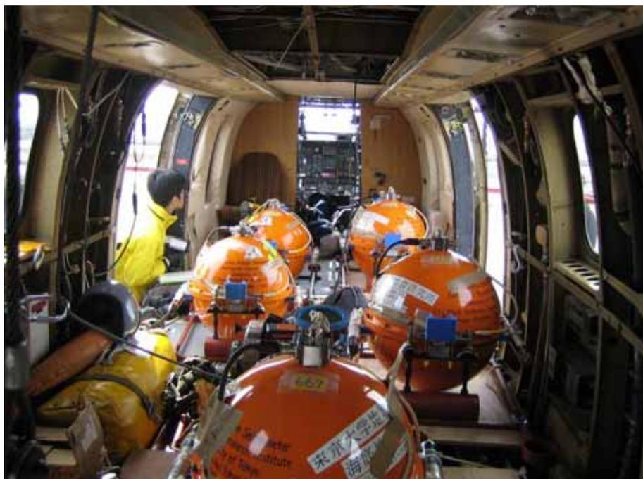
図3 三陸北部沖に設置するため大型ヘリコプター（朝日航洋株式会社所属）に積み込んだ長期観測型海底地震計
