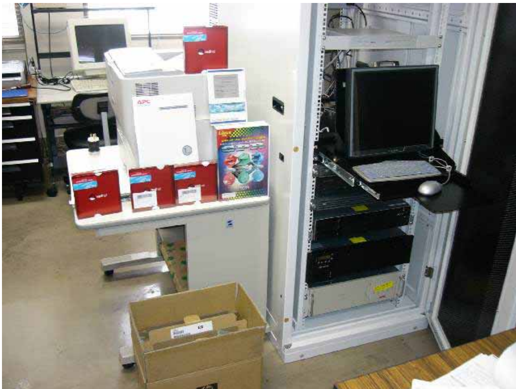
図1 大容量海底地震データ保存用ファールサーバ用計算機(右)と地震波形処理用計算機にインストールしたOS、およびアプリケーション・ソフト(左)
