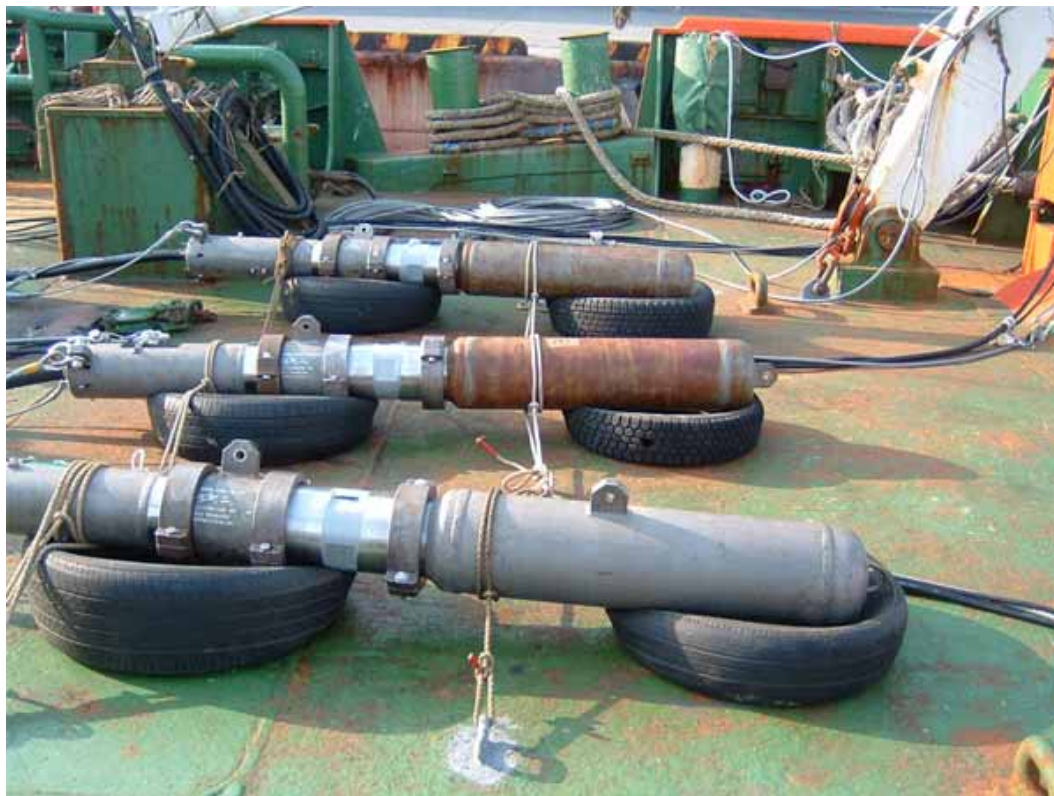
写真 1 根室沖・釧路沖の浅部構造調査のために、使用したエアガン（平成 18 年 5 月）
