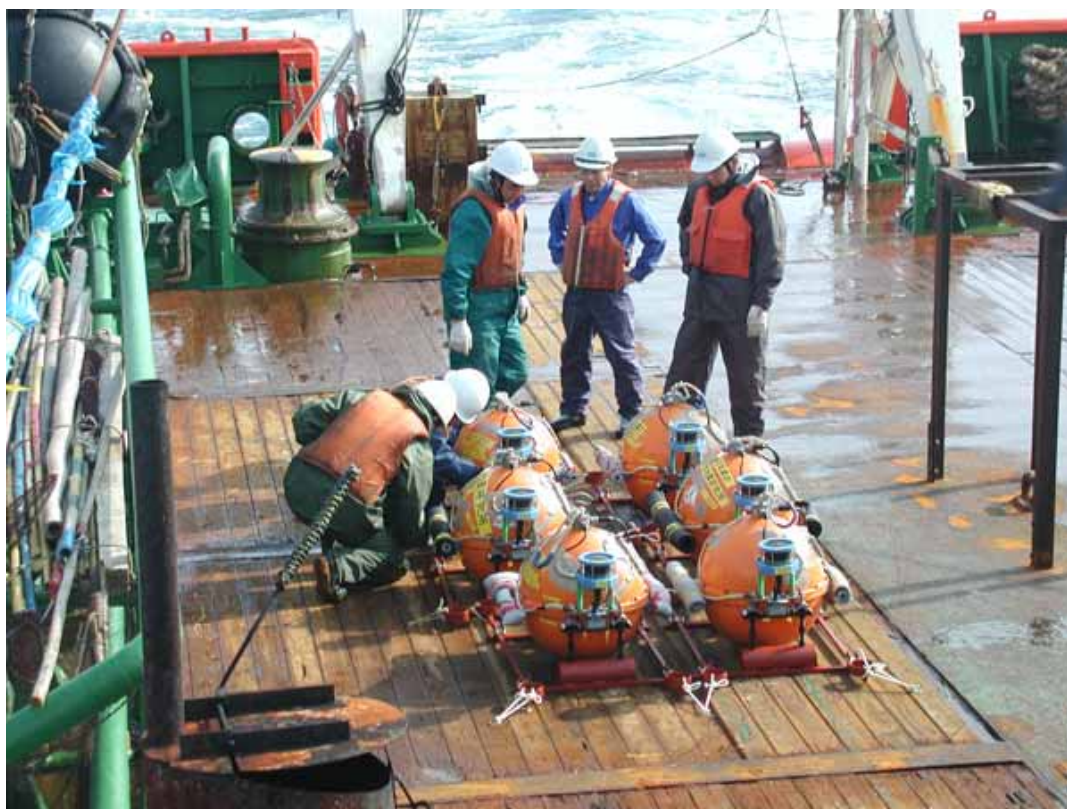
写真4 三陸沖北部から十勝沖にかけての領域に設置される海底地震計（平成18年10月）
