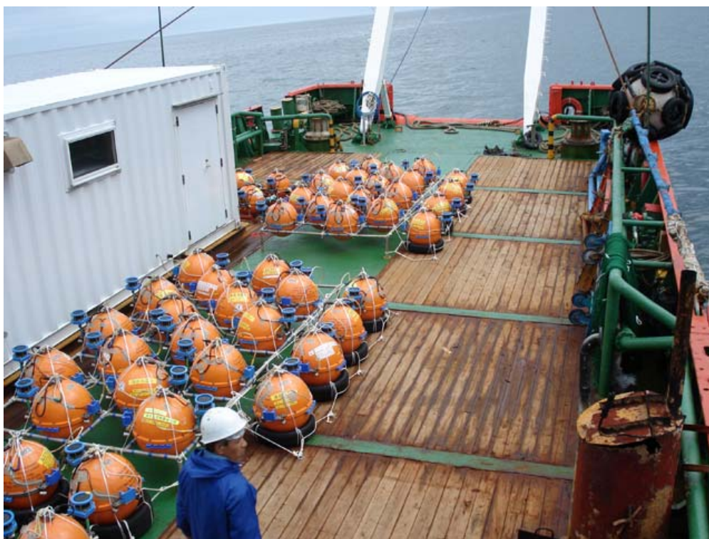
写真 1 三陸沖南部から福島沖北部から回収された海底地震計（平成 20 年 6 月）
