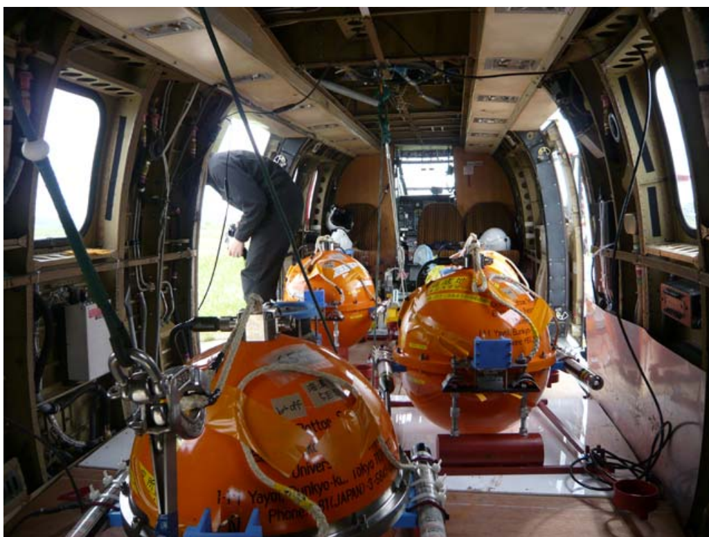
写真 2 福島県から房総半島沖の海域に大型ヘリコプターで設置される海底地震計（平成 20 年 5 月）
