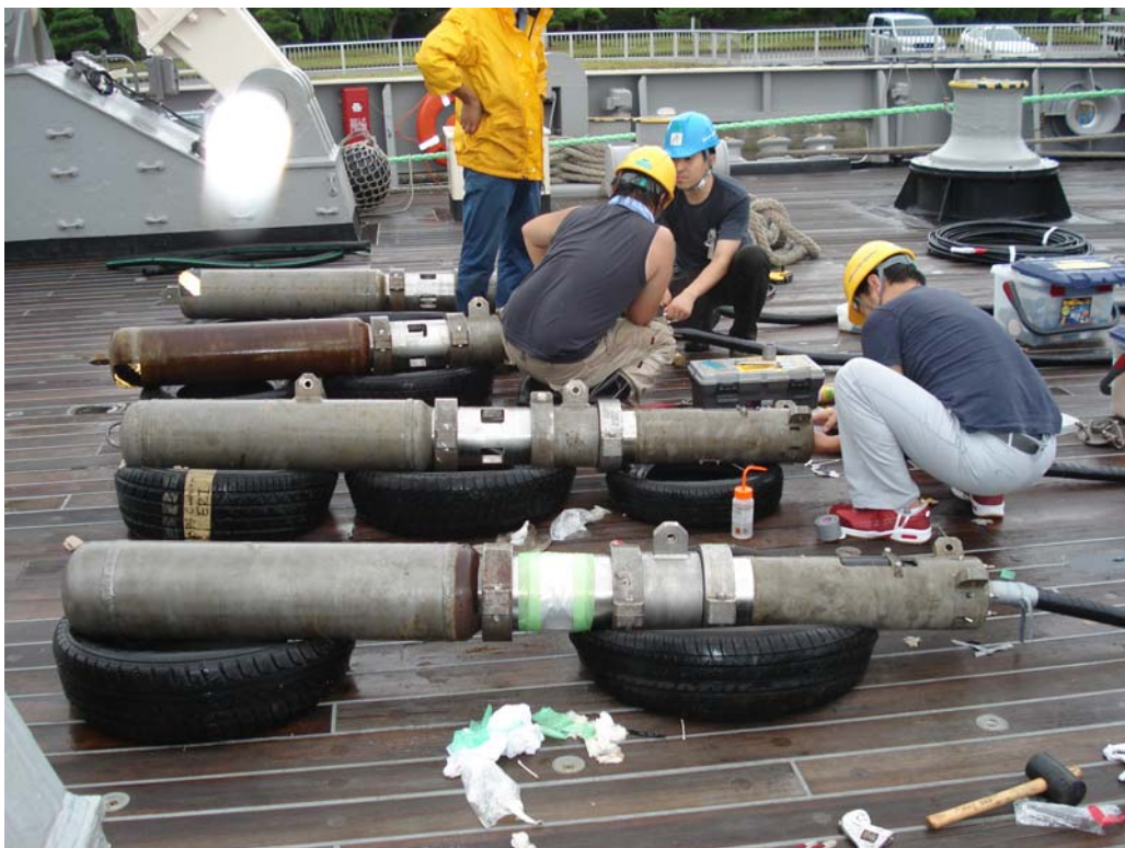
写真3 福島県から房総半島沖の構造調査のために使用したエアガン（平成20年9月）
