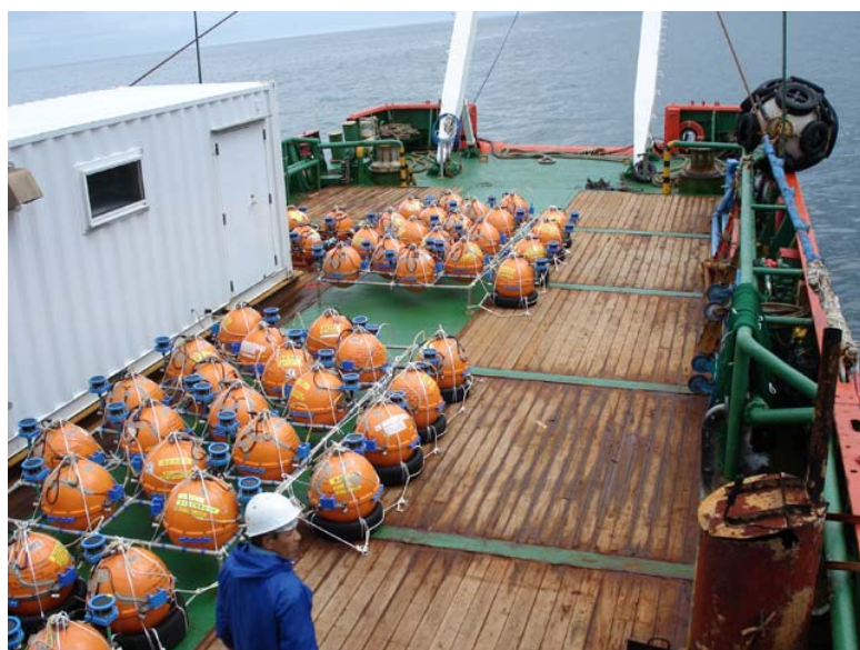
約1年間の海底地震観測後に三陸沖南部から福島沖北部の領域から回収された長期観測型海底地震計群（平成20年6月）
