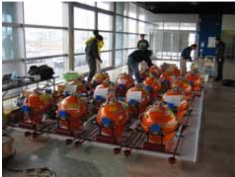
設置前の最終調整作業中の長期観測型海底地震計（青森県八戸市の臨時ヘリポート近くの臨時作業スペースにおいて）
