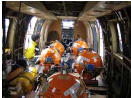
三陸北部沖に設置するため大型ヘリコプター（朝日航洋株式会社所属）に積み込んだ長期観測型海底地震計
