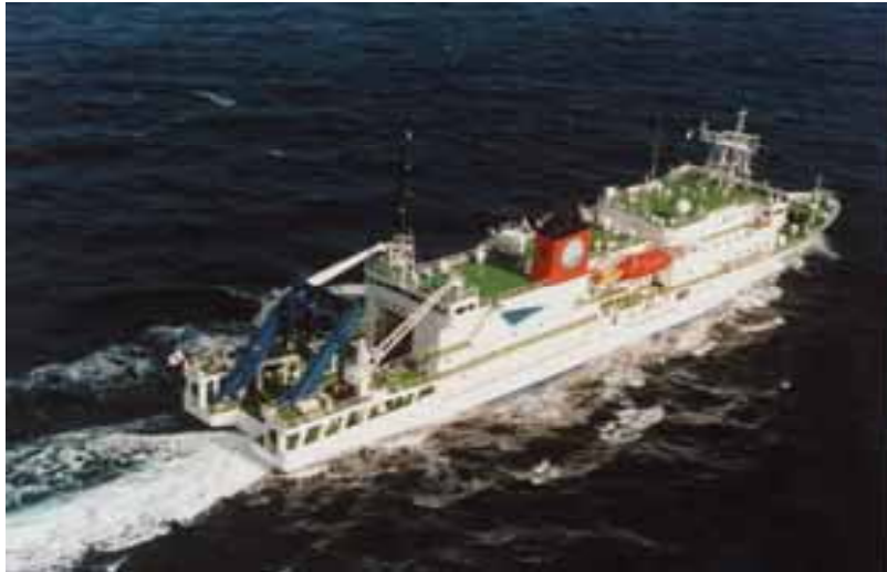
反射法調査用 「かいりい」4628トン エアガン 約200リットル ストリーマーケーブル 156ch 約4000mストリーマー長
