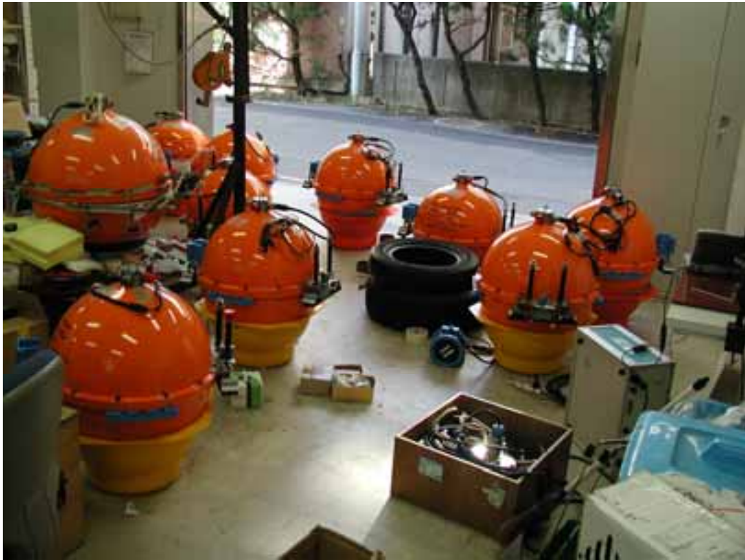
図 3-5 長期観測型海底地震計の組立作業 - 地震 9 台の組み上げ完了
