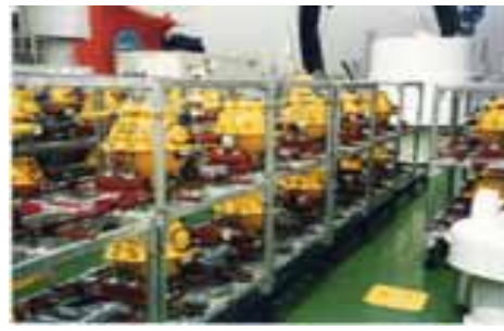
反射法調査用 「かいりい」4628トン エアガン 約200リットル ストリーマーケーブル 156ch 約4000mストリーマー長
