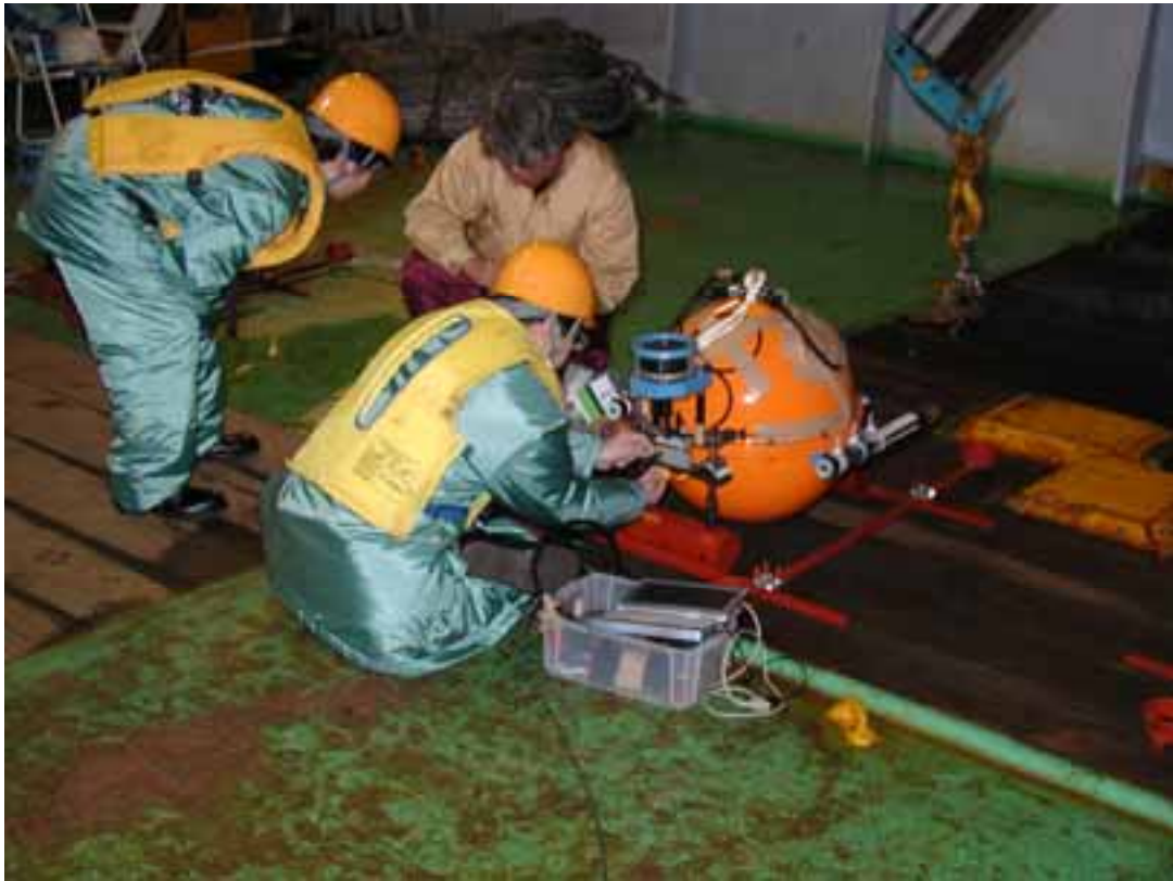
図 6-5 長期観測型海底地震計の投入準備作業
