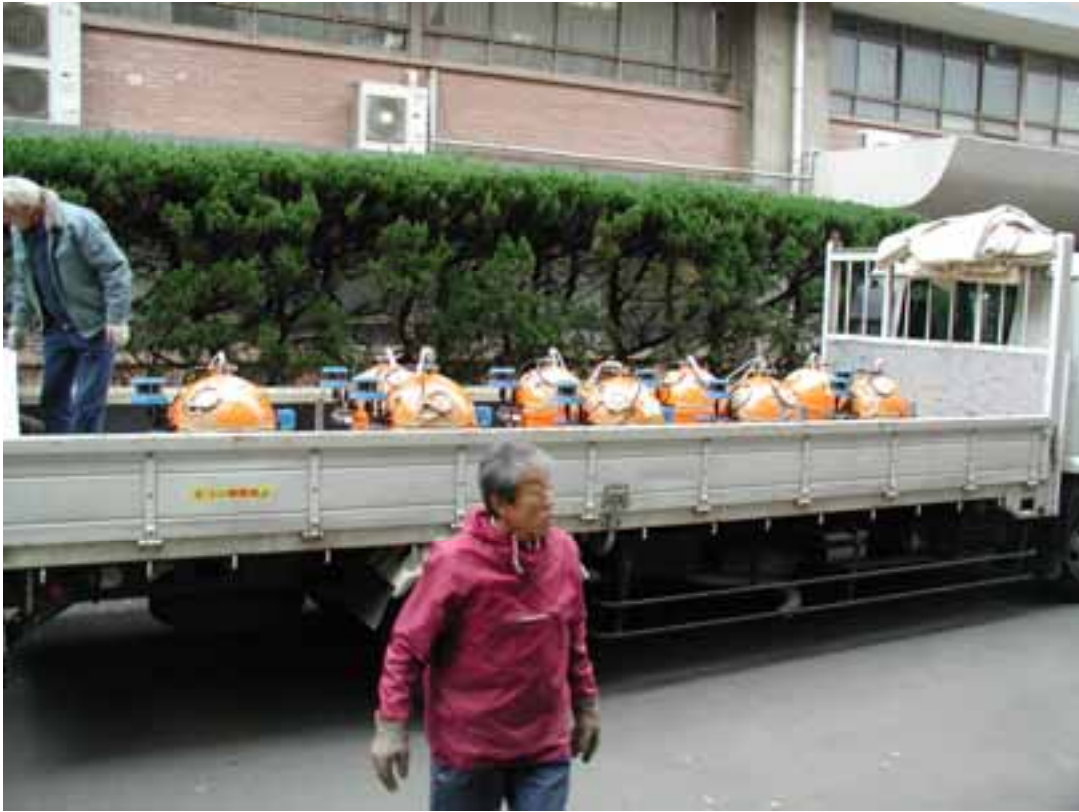
図 6-1 長期観測型海底地震計の設置作業 - 地震計の搬出作業
