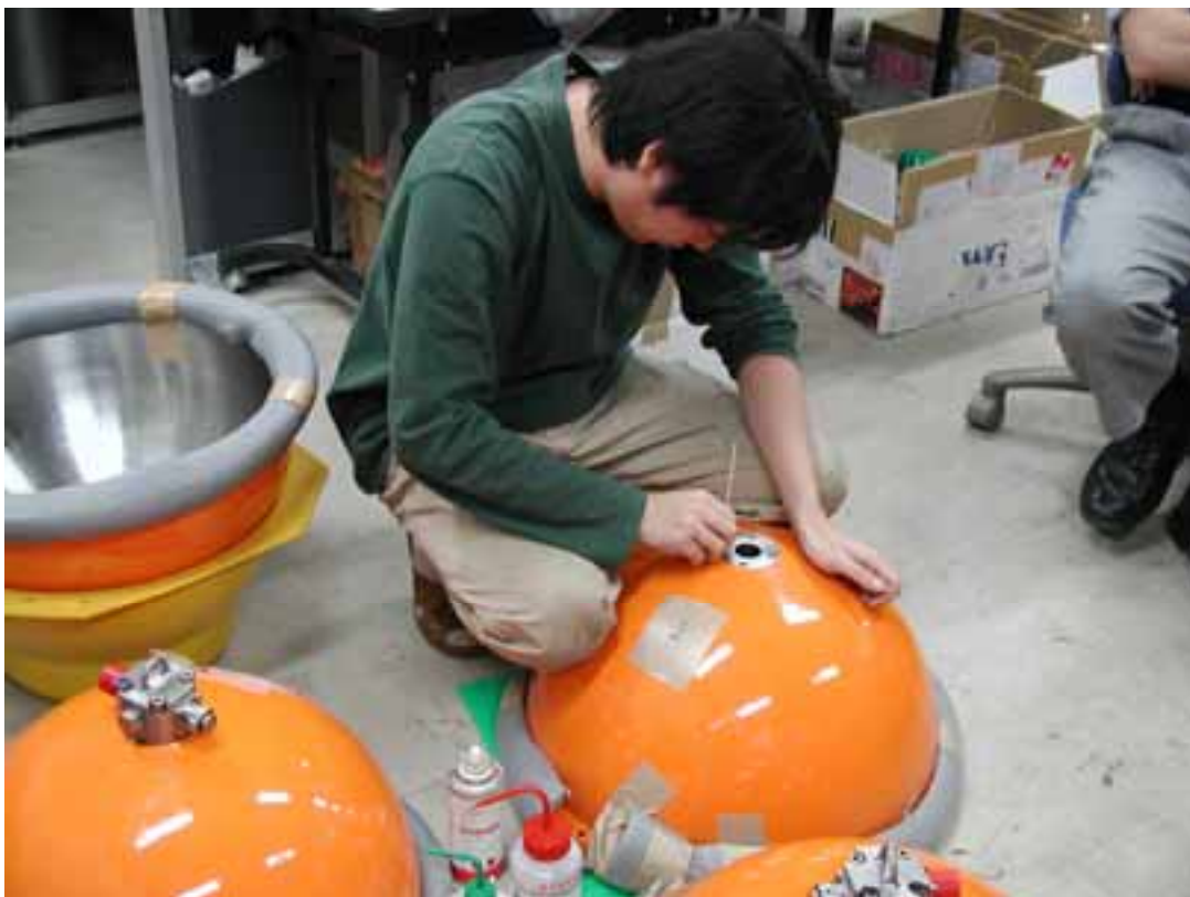
図 3-4 長期観測型海底地震計の組立作業 - チタン球上半球へのコネクター取り付け
