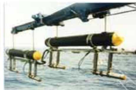
広角反射・屈折法調査用 「かいよう」3176トン エアガン 約200リットル 海底地震計(OBS) 100台
