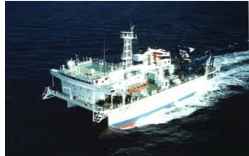
広角反射・屈折法調査用 「かいよう」3176トン エアガン 約200リットル 海底地震計(OBS) 100台
