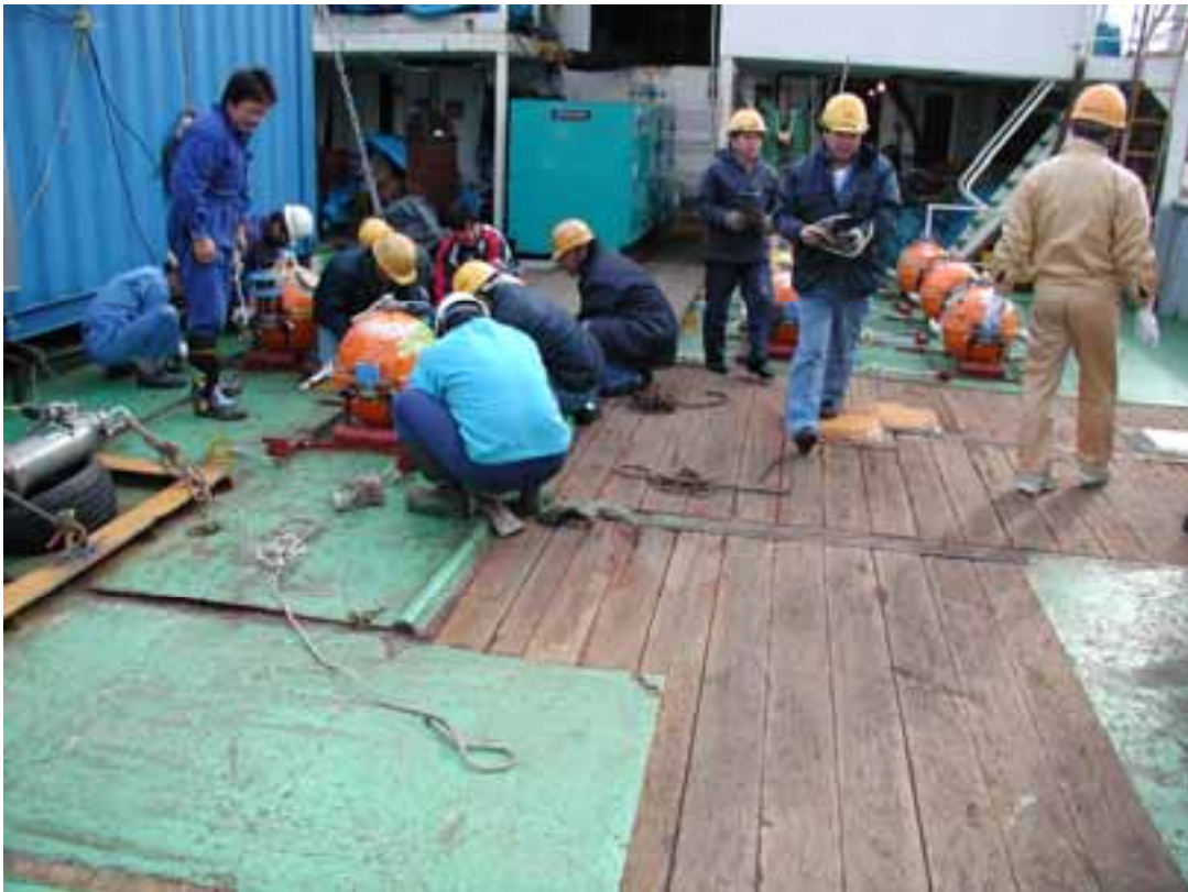
図 6-2 長期観測型海底地震計の観測作業船「新辰丸」甲板上への搬入・固縛作業
