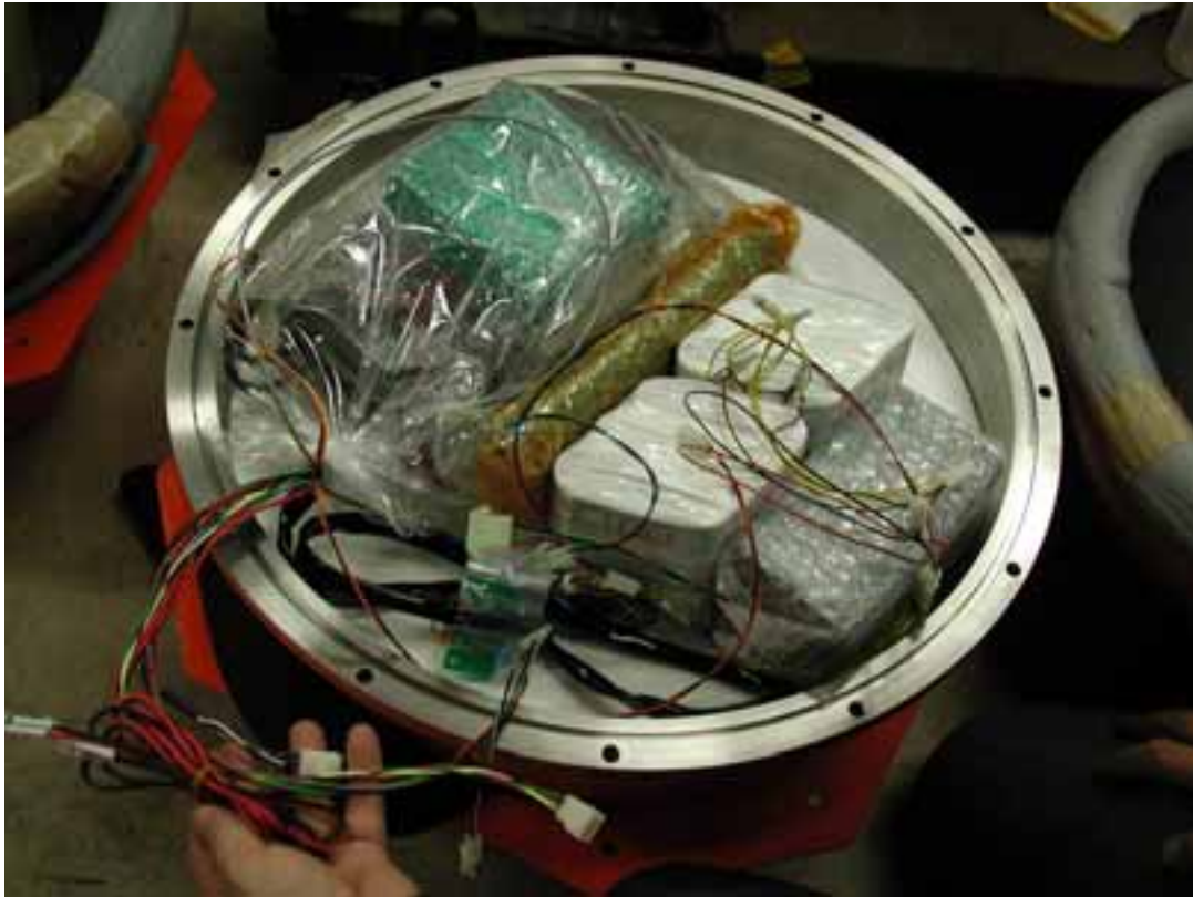
図 3-3 長期観測型海底地震計の組立作業 - チタン球への組み込み
