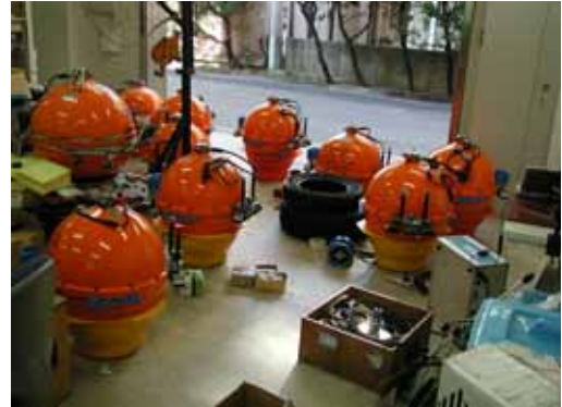
整備作業中の長期観測型海底地震計
